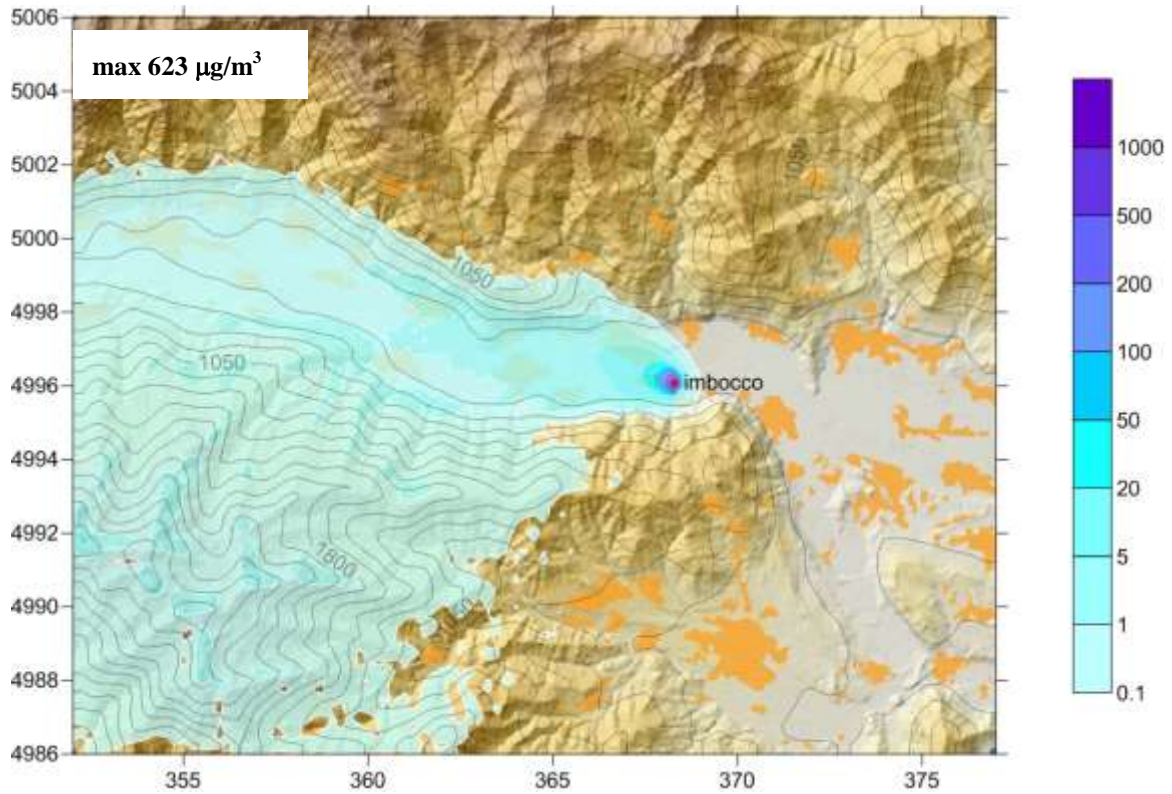
Figura 61 - Campo di concentrazioni di \text{NO}_x massime al suolo delle medie su 10 minuti, relativo all'intero intervallo di simulazione. Valori in \mu\text{g}/\text{m}^3 secondo la scala a destra.
