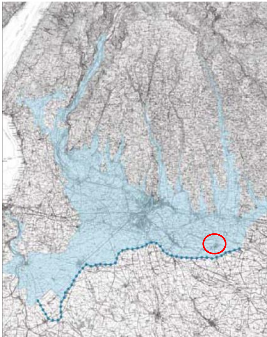
Figura 4.1 – Estensione dell'acquifero (area azzurra) Alta Pianura Veronese (da ARPAV, 2008). La linea blu indica la linea delle risorgive, l'ellisse rossa individua l'area in esame.
