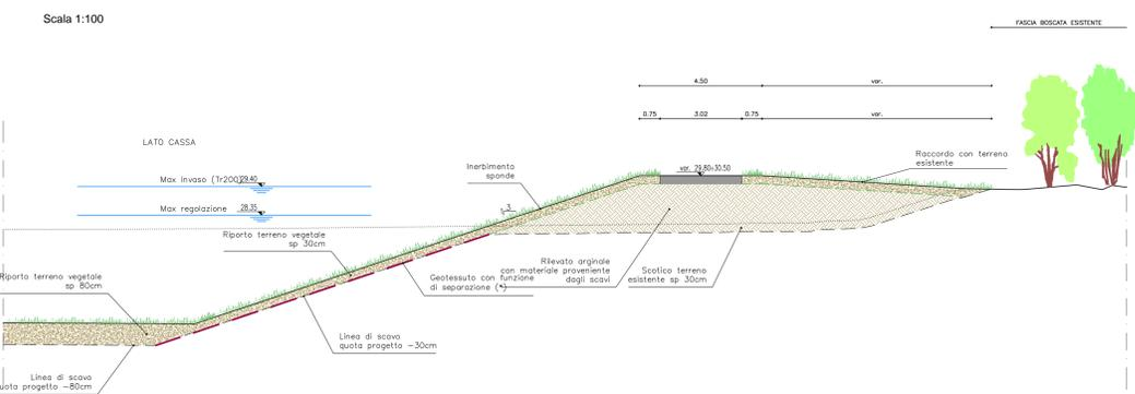
SEZIONE TIPO CANALE DI RESTITUZIONE
