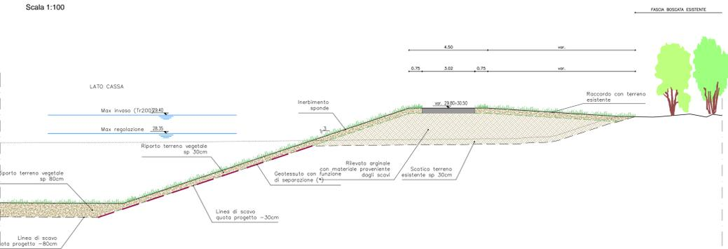
SEZIONE TIPO CANALE DI RESTITUZIONE
