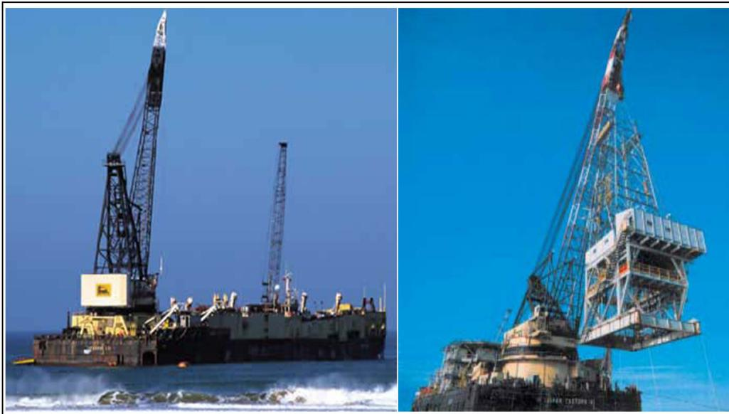
**Figura 3-26: immagini del mezzo navale di sollevamento tipo Crane-Barge**
