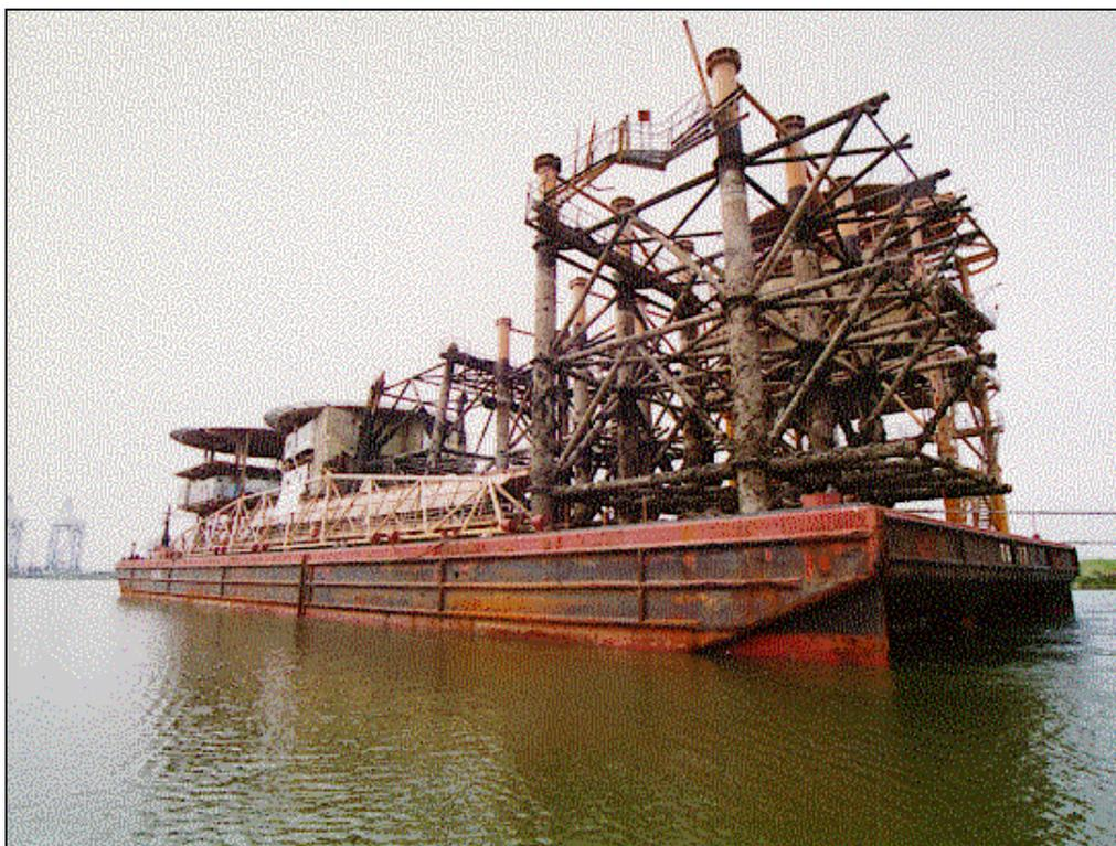
**Figura 3-32: trasporto delle strutture rimosse**
