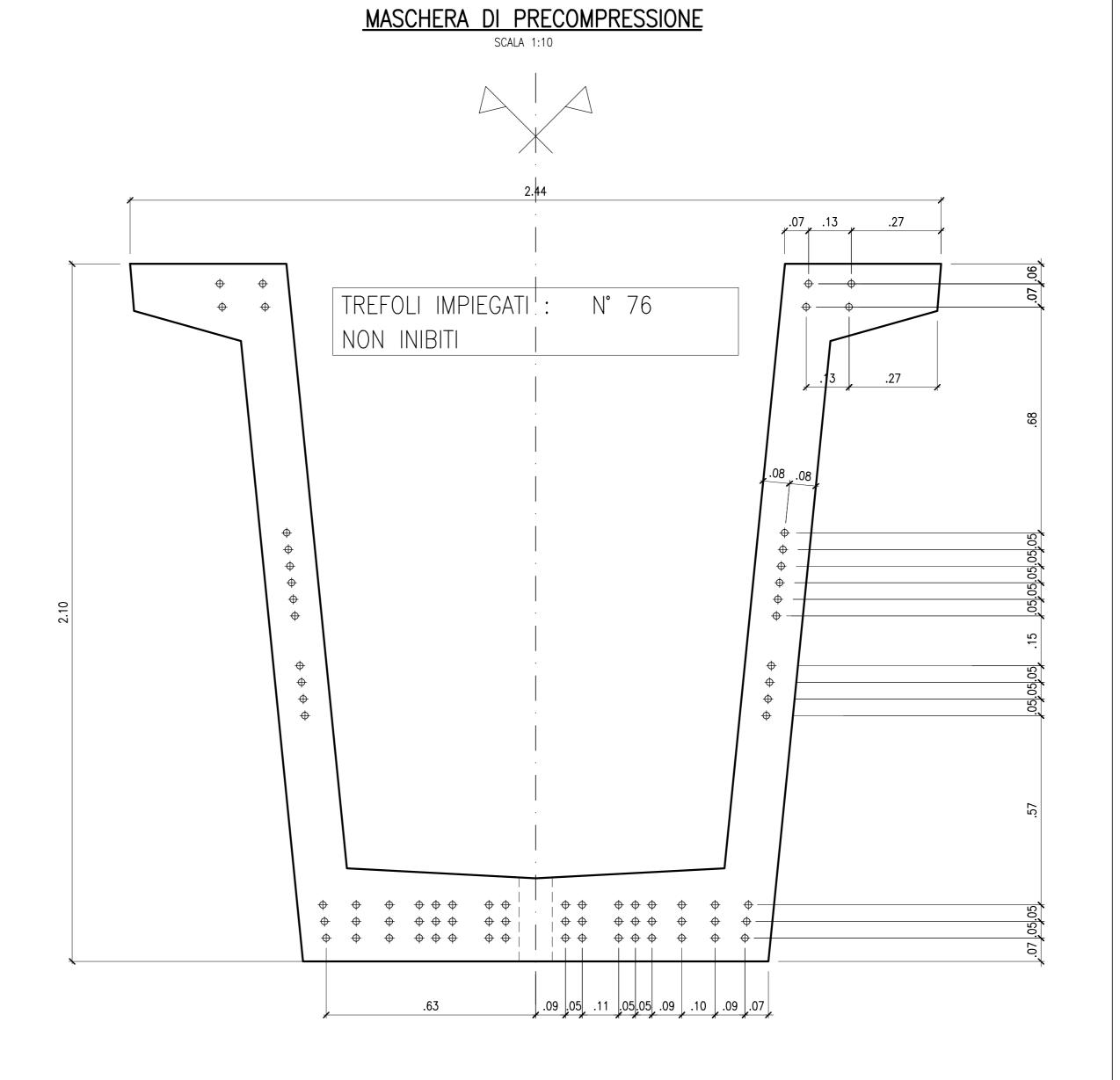
Materiali: ACCIAIO PER C.A.P. Trefoli Ø0.6" fptk = 1860 MPa fp(0.1)k = 1670 MPa Trattamento di stabilizzazione
