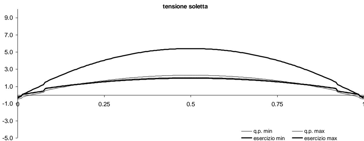
**Figura 7 – sviluppo delle tensioni sulla soletta (MPa) su tutte le sezioni del ponte**
