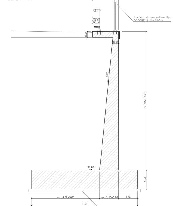
SEZIONE MURO DI SOTTOSCARPA
