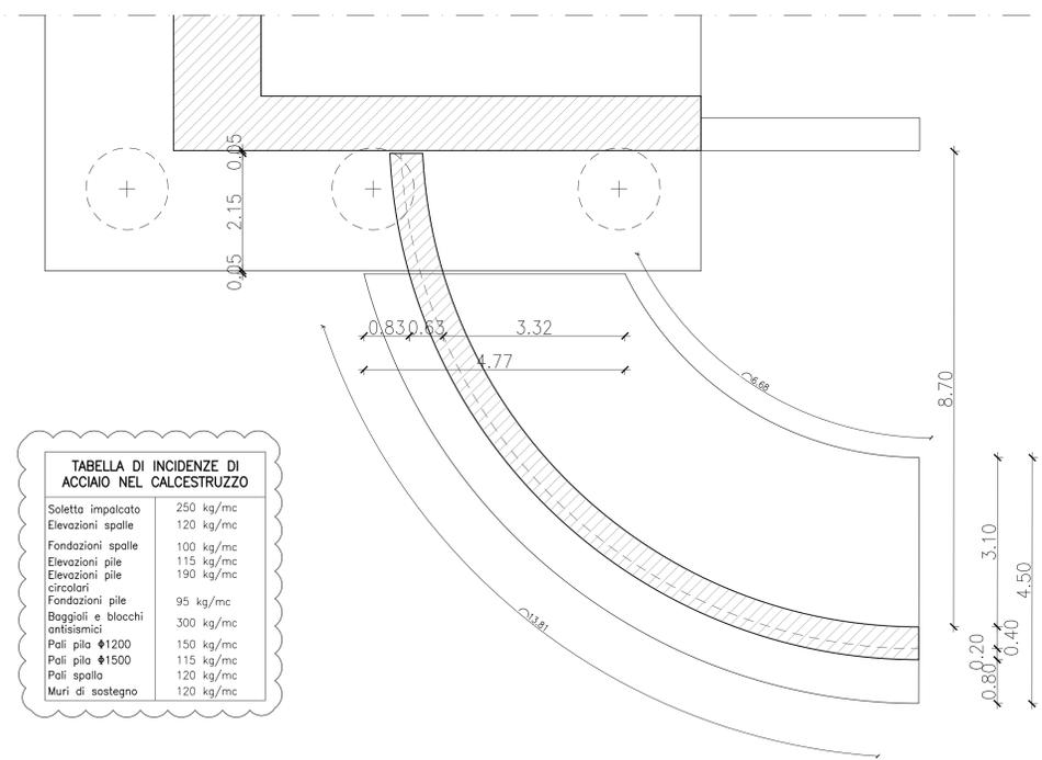
SEZIONE X-X: MURO TIPO C
