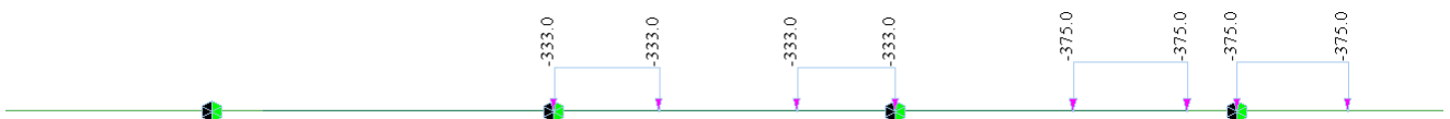
Figura 61: Disposizione dei carichi concentrati (Schema di carico 1) per massimizzazione del momento sull'appoggio
