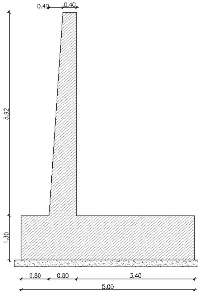
Figura 4: Sezione Muro – parte costante di sottoscarpa
