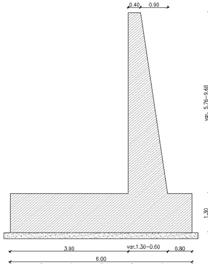
Figura 3: Sezione Muro – prosecuzione spalla altezza variabile
