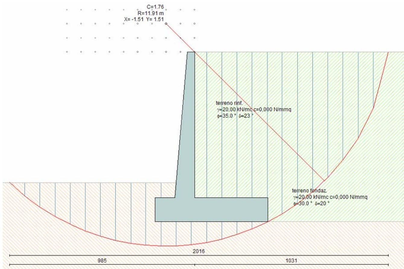
Figura 10: Stabilità globale del sistema terra-muro
