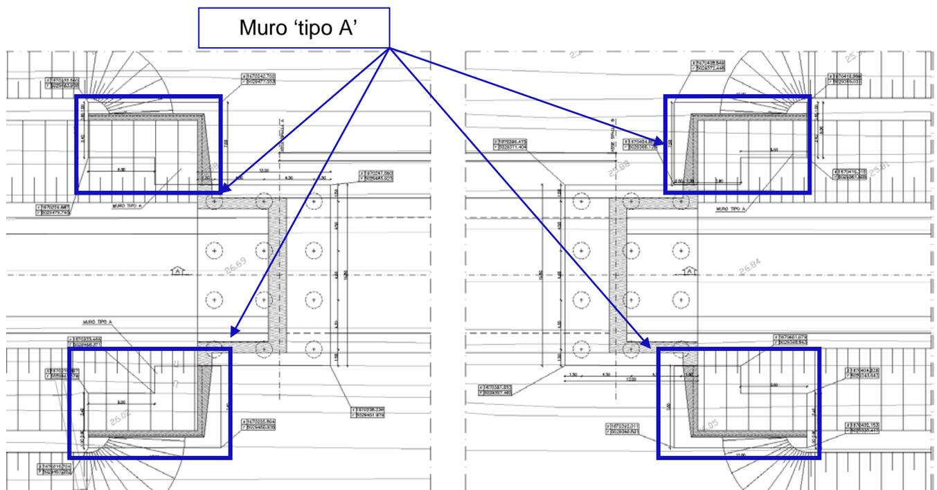
Figura 1: Stralci planimetrici: ubicazione muri in c.a. lato spalla A e lato spalla B
