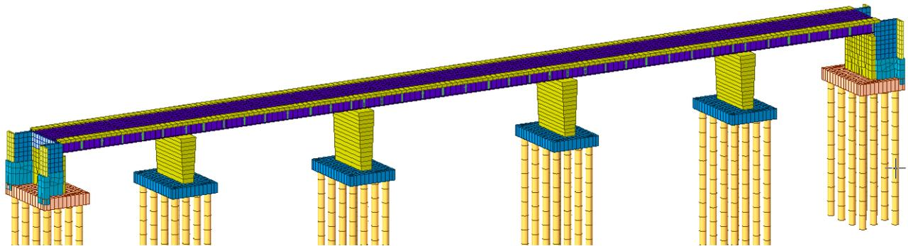
Figura 28: Modellazione tridimensionale Elementi finiti – modello 3d globale
