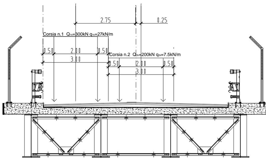
Figura 13: Disposizione delle colonne di carico sull'impalcato
