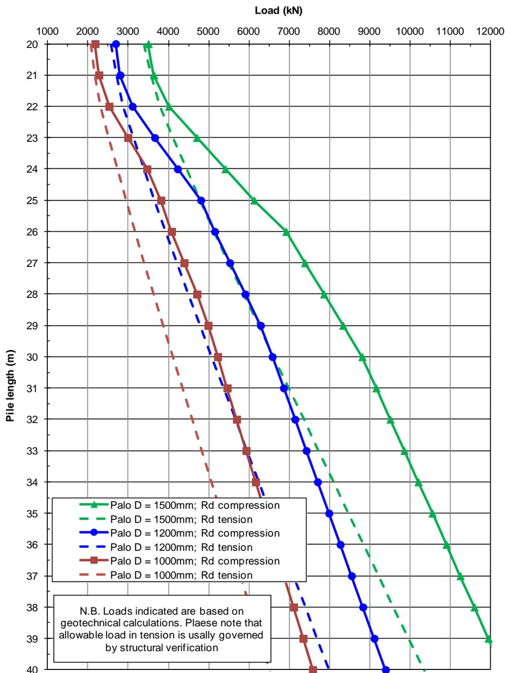
Figura 34: Approccio 1 Combinazione 1 - A1M1R1: Resistenza di progetto
