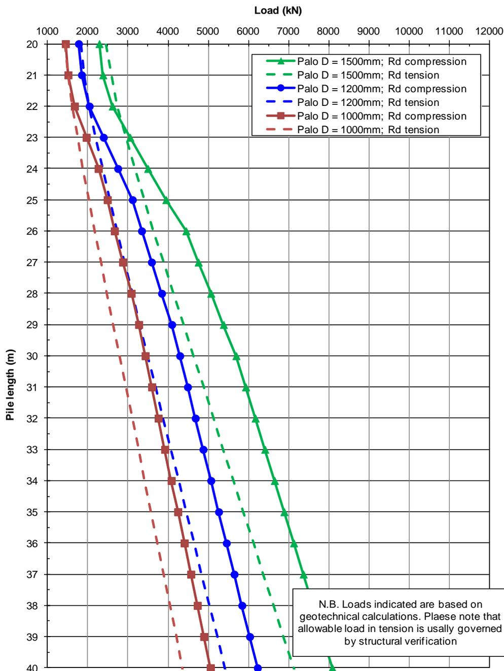
Figura 38: Approccio 1 Combinazione 2 – A2M1R2: Resistenza di progetto
