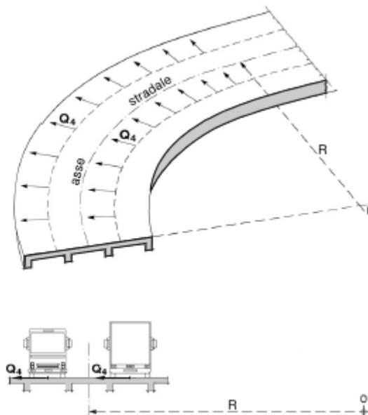
Figura 14: Valori caratteristici delle forze centrifughe - Tabella 5.1.III del D.M. 14 gennaio 2008
