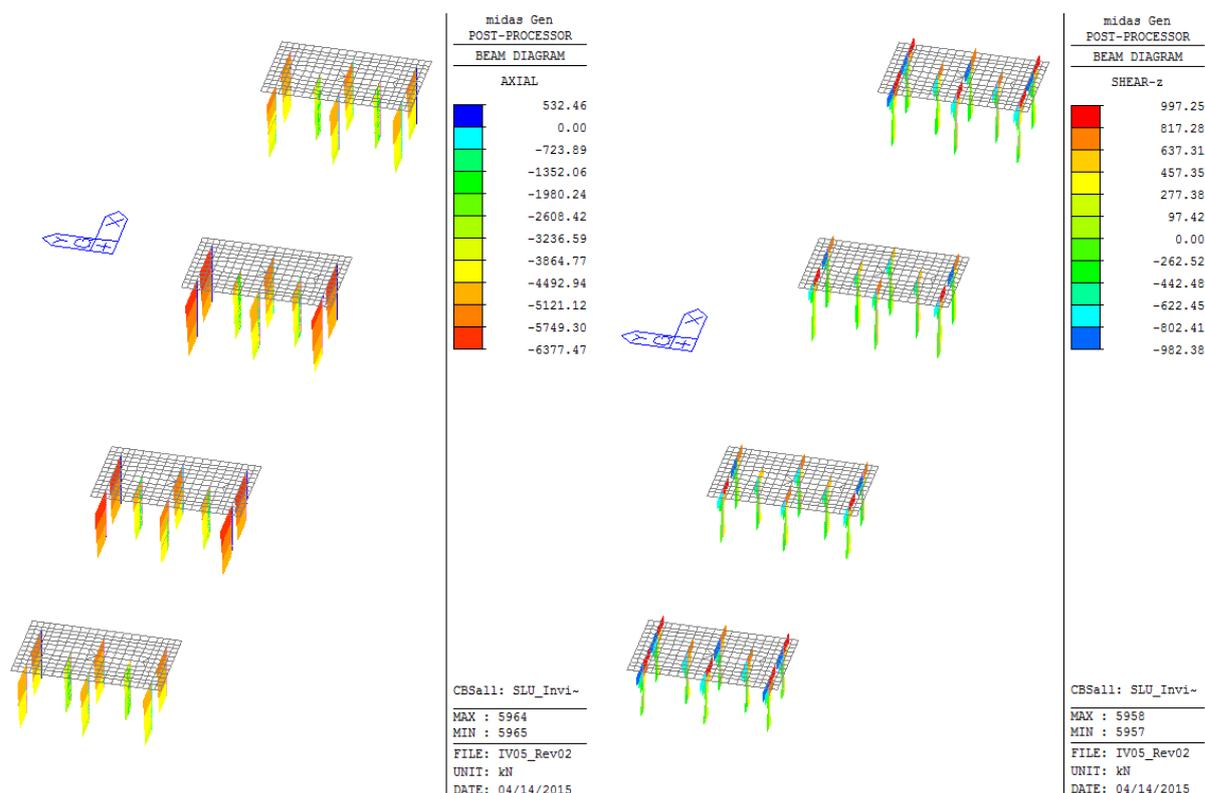
Figura 36: Combinazione SLU SISMA: – Involuppo Sforzo Normale e tagli
