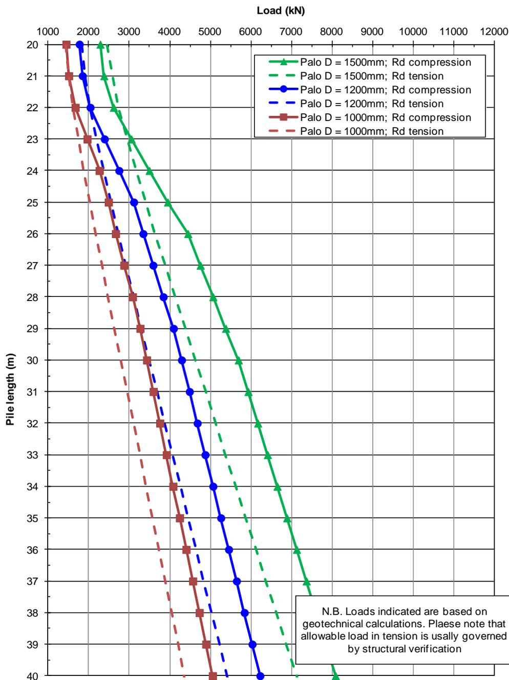
Figura 35: Approccio 1 Combinazione 2 – A2M1R2: Resistenza di progetto
