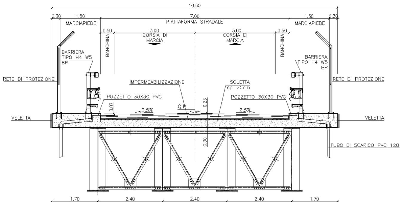
Figura 7: Sezione trasversale
