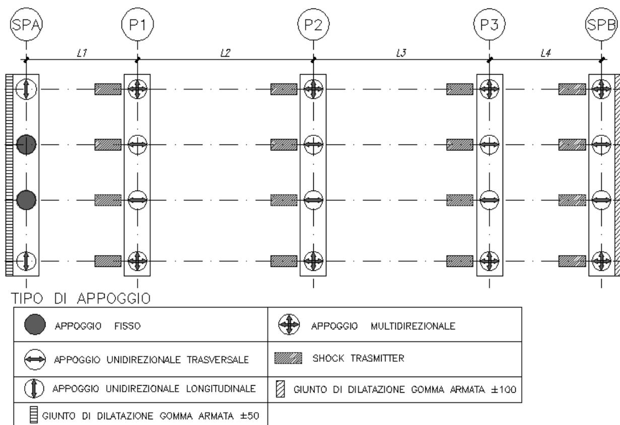
Figura 27: Schema dei vincoli di appoggio dell'impalcato
