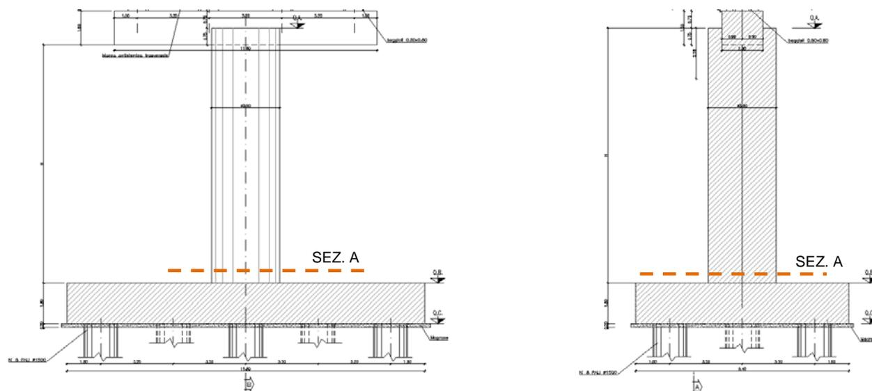
Figura 38: Identificazione delle sezioni di calcolo
