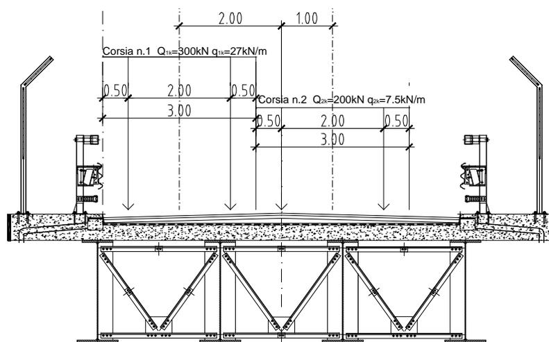
Figura 13: Disposizione delle colonne di carico sull'impalcato
