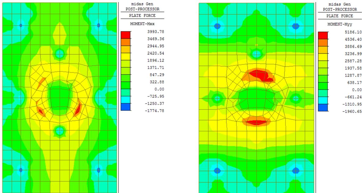
Figura 41 Comb. SISMA: – Involuppo Momenti Mtrav (a sinistra) ;Mlong (a destra)
