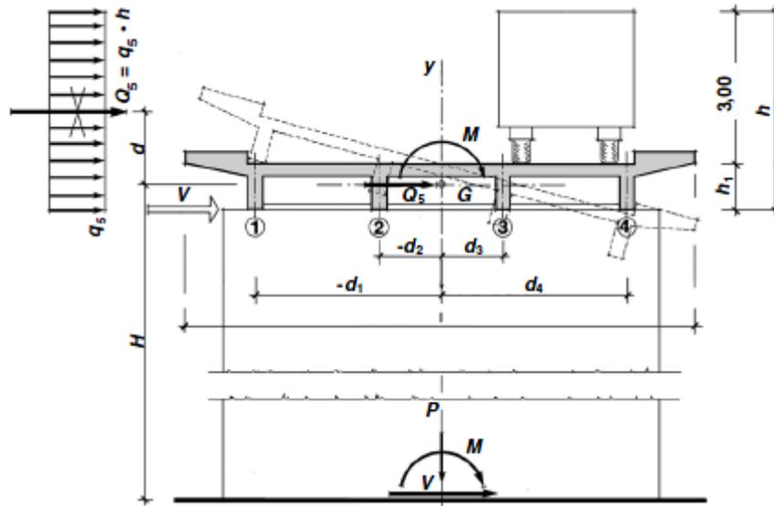
Figura 15: Direzione dell'azione del vento sul ponte
