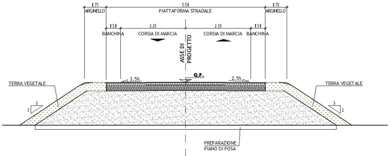
Figura 7: Sezione tipo strada vicinale
