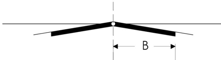
Per effetto della rotazione dei cigli, si genera una sovrappendenza  $\Delta_i$  nelle linee di estremità della carreggiata rispetto alla pendenza dell'asse di rotazione. Tale sovrappendenza è pari a:
