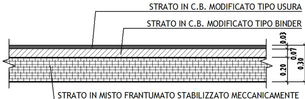
Figura 12: Particolare pavimentazione strada vicinale
