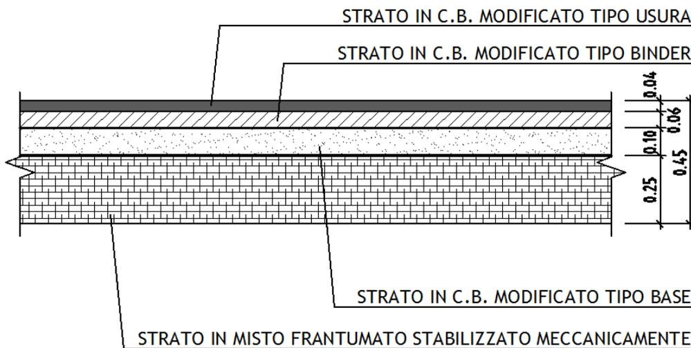
Figura 11: Particolare pavimentazione strada categoria F
