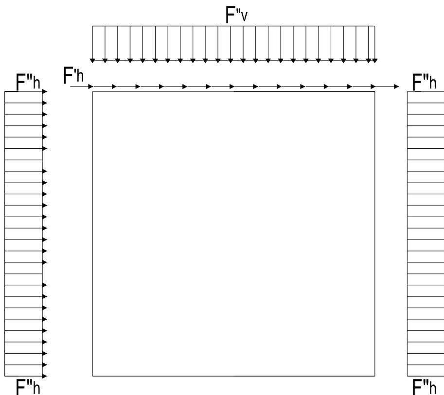
**Figura 5 - Forze sismiche agenti sulla struttura**
