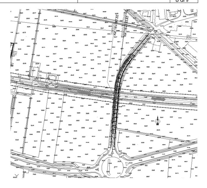
Dal punto di vista planimetrico il nuovo asse di progetto insiste sopra la strada esistente per evitare di dover acquisire nuove aree private e si è cercato di mantenere elementi geometrici che meglio si adattano alla situazione esistente.
