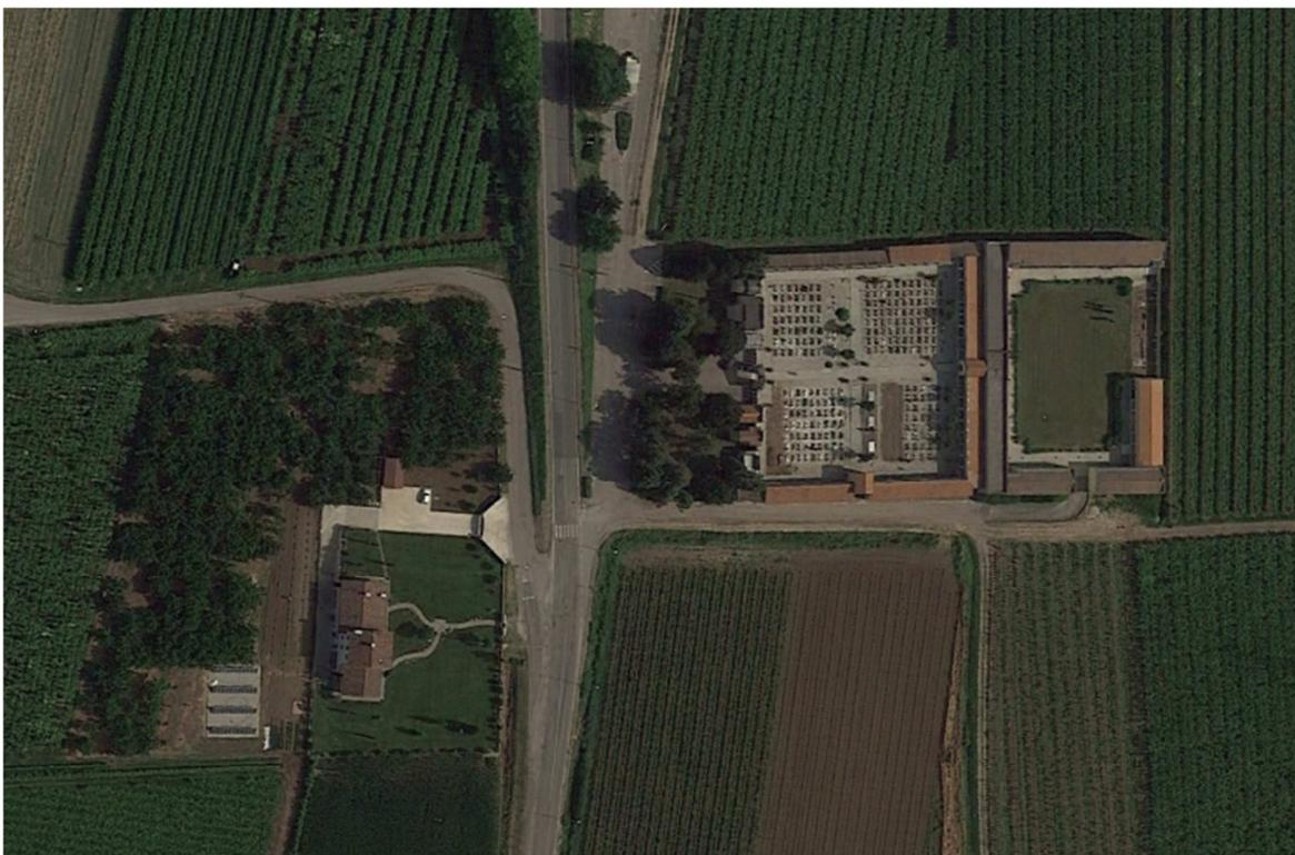
La visibilità di innesto sia dal cimitero che dalla viabilità locale in direzione nord risulta molto problematica e poco sicura sia per i ridotti raggi di manovra che per la mancanza di visibilità per i veicoli provenienti dal cavalcaferrovia (presenza anche di barriere di sicurezza sul bordo laterale).
