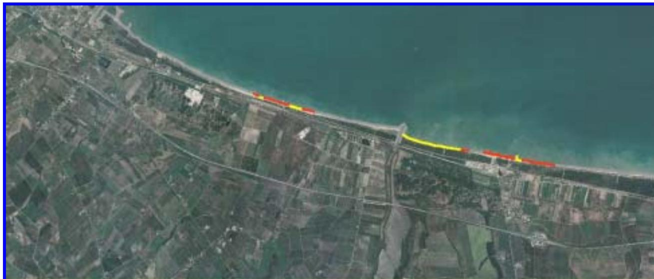
*Fig 13 - Classificazione della costa in base all'entità di arretramento tra il 1954 ed il 1999: in rosso la classe 15-30 metri , in giallo la classe 30-50 metri.*
