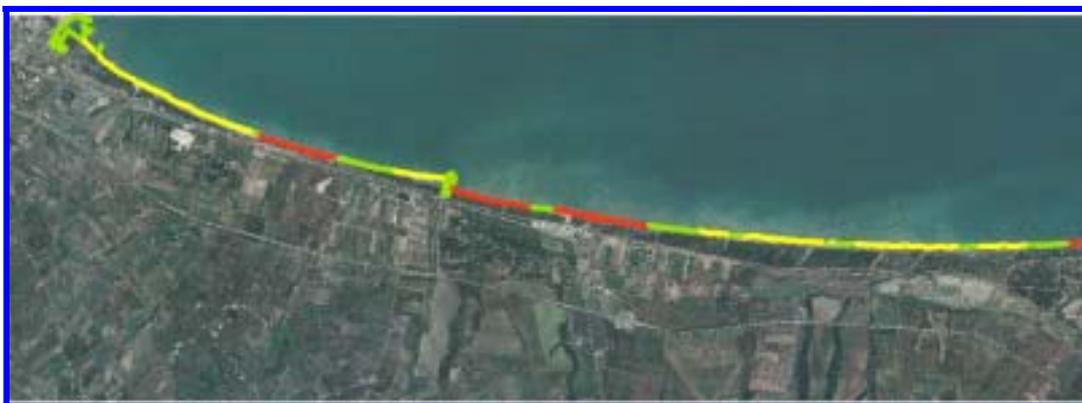
Fig.11- Classificazione del litorale nella zona di studio di dettaglio in base alla sua mobilità nell'intervallo 1954-1999 (in rosso i tratti in arretramento, in giallo i tratti in avanzamento e in verde i tratti in cui non è possibile evidenziare la presenza di variazioni).
