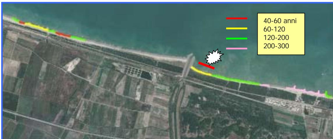
**Fig. 18 - Valutazione del tempo in cui l'attuale massicciata ferroviaria verrà interessata dall'azione diretta dell'erosione del mare sulla base di estrapolazione dell'evoluzione della linea di costa dal 1954 ad oggi.**
