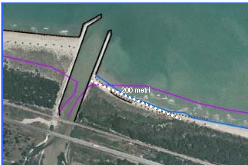
*Fig7 Particolare del tratto (di circa 200 metri di lunghezza) a sud della foce armata del Torrente Saccione in arretramento sin dal 1954 (in viola la posizione della costa al 1954); i puntini indicano i rilievi con DGPS al maggio 2003.*
