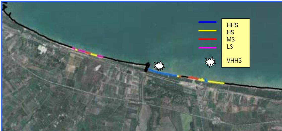
**Fig. 15 - Classificazione dei tratti di litorale in arretramento in funzione della suscettibilità all'erosione della fascia costiera calcolata in base alla relazione tra entità arretramento nel tempo (1954-1999 oppure 1954-2003) ed ampiezza della spiaggia rispettivamente al 1999 e ad oggi.**
