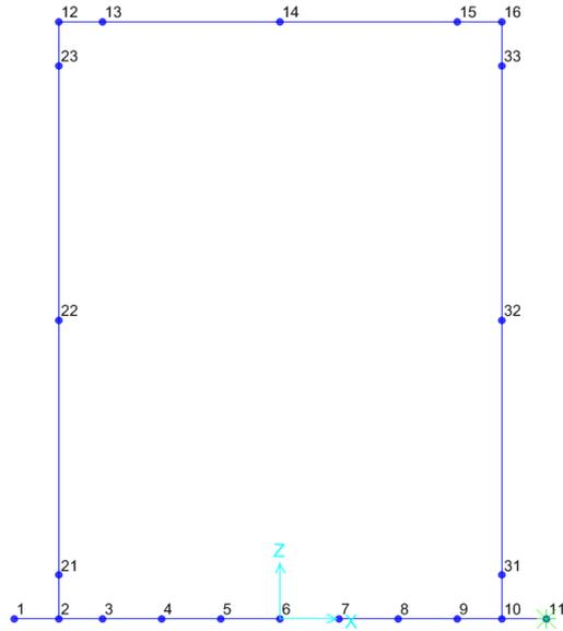
Figura 8 - Modello F.E.M struttura - numerazione nodi
