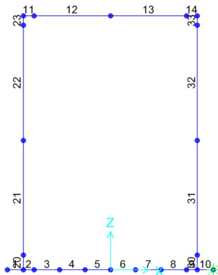
Figura 8 - Modello F.E.M. struttura – numerazione aste
