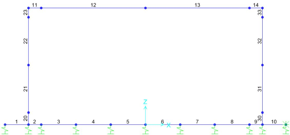
Figura 8 - Modello F.E.M. struttura – numerazione aste
