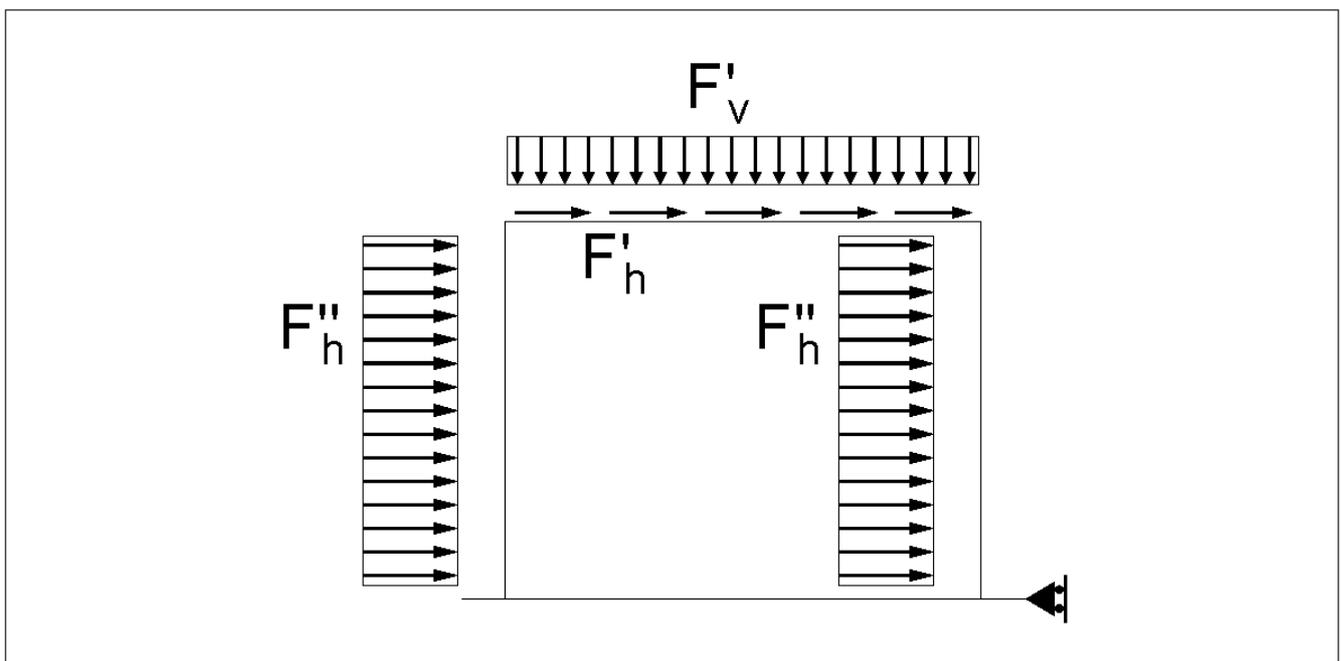
**Figura 6 - Forze sismiche agenti sulla struttura**
