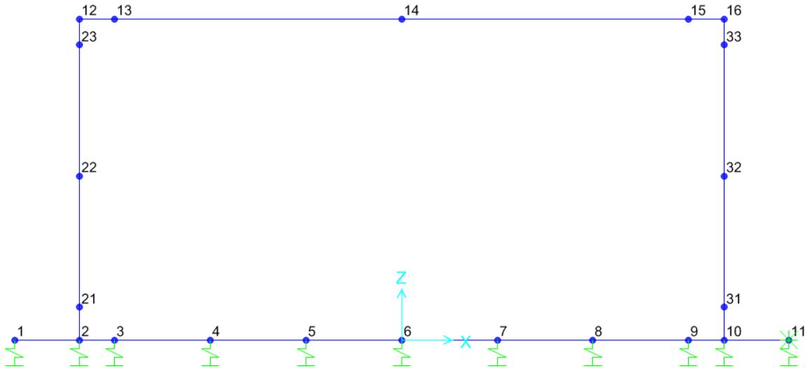
Figura 7 - Modello F.E.M struttura - numerazione nodi
