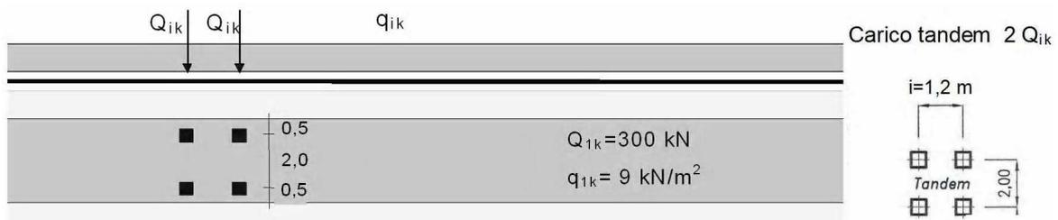
Figura 4 – Schema di Carico 1
