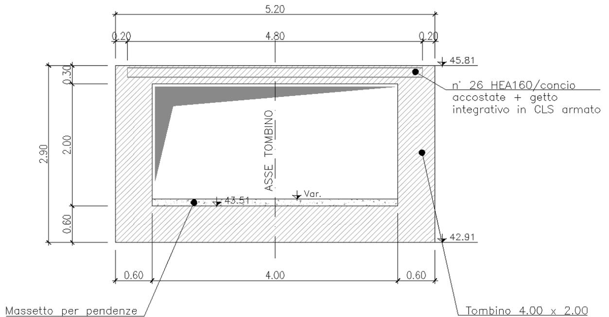
**Figura 2 - Sezione trasversale**
