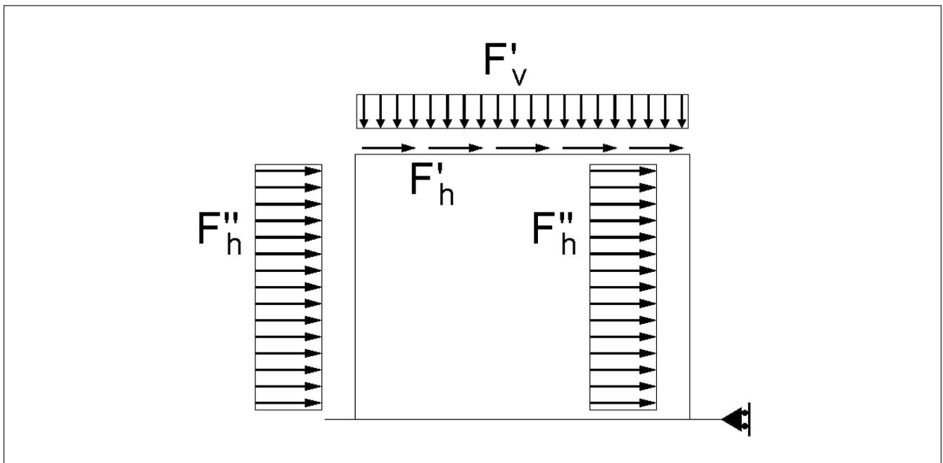
Figura 5 - Forze sismiche agenti sulla struttura
