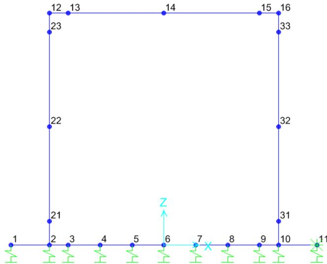
Figura 7 - Modello F.E.M struttura - numerazione nodi
