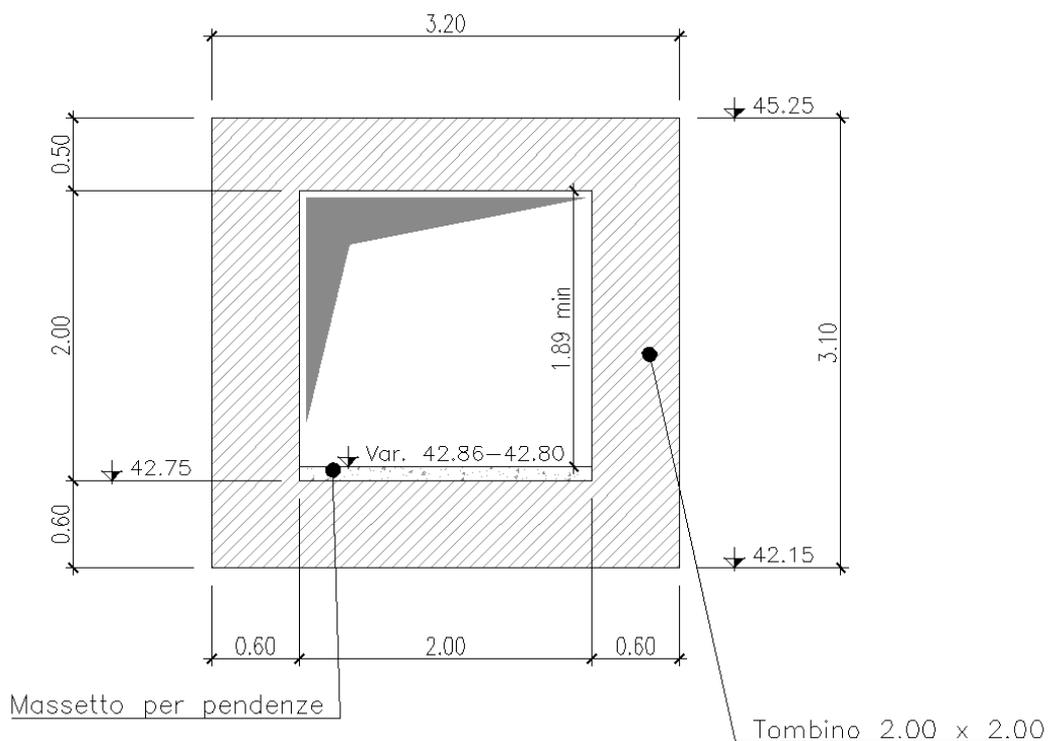
**Figura 3 - Sezione trasversale**
