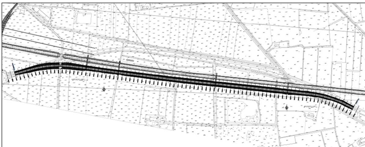
La nuova Linea ferroviaria interferirebbe con la viabilità esistente in due punti distinti, per cui, è stato deciso di realizzare una nuova configurazione sia planimetrica che altimetrica in modo tale che il nuovo tronco rimanga sempre al di sotto del rilevato ferroviario garantendo un sufficiente distanziamento con esso.
