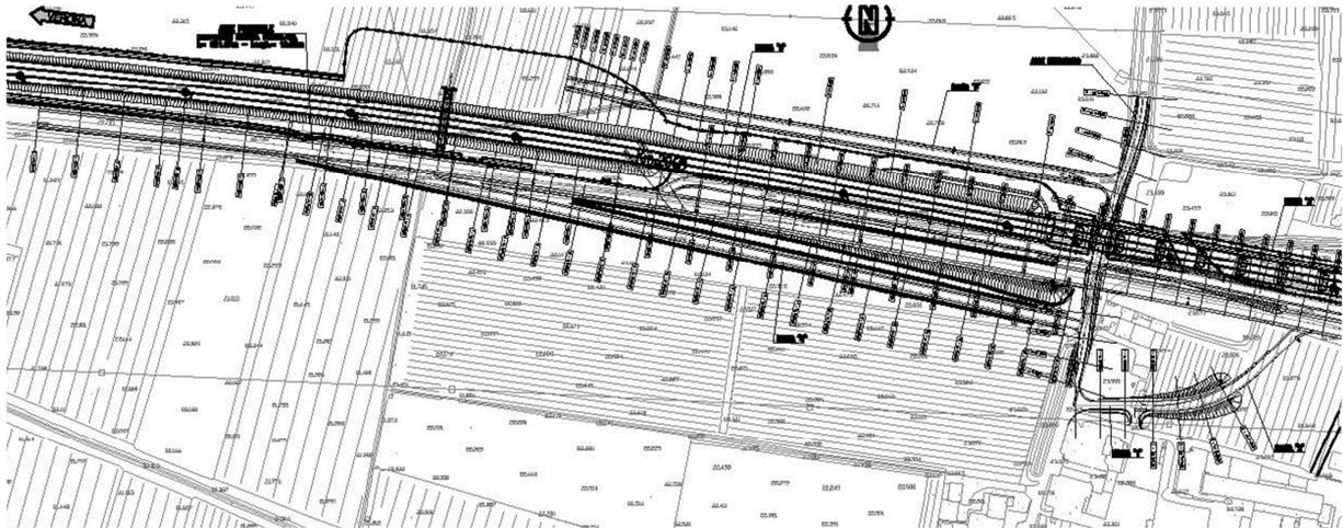
Essendo la viabilità di adeguamento di un tracciato esistente, per le verifiche di tracciato, si garantisce una Vp superiore di 10 Km/h rispetto al limite amministrativo esistente (50Km/h).
