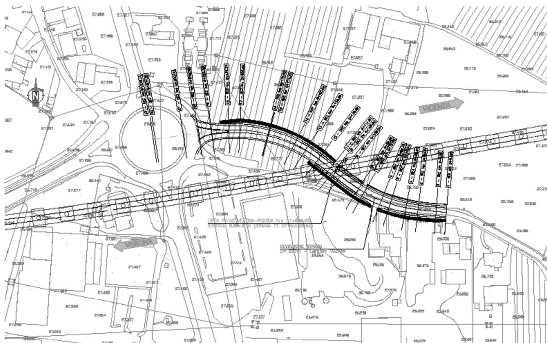
La viabilità di esistente interferirà con le pile di un viadotto della nuova Linea AV .
