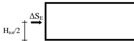
**Figura 12 – Spinta sismica del terreno secondo la teoria di Wood**
