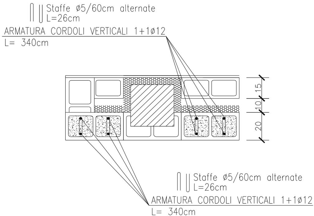
Come prevede la normativa, le due murature interna ed esterna devono essere collegate. Tali collegamenti sono realizzati tramite tralicci zancati di larghezza pari a 20 cm, composti da 2 $\varnothing 5$  + diagonali  $\varnothing 4$  con passo di 40 cm, inseriti ogni tre corsi di mattoni, posizionati tra le 2 murature.. Nelle murature perimetrali viene inserito un cordolo orizzontale lungo tutto il perimetro dell'edificio che fa anche da architrave a porte e finestre. ( Vedere esempio sotto )
