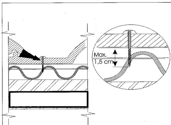
Quando necessario sarà possibile fissare, tramite vite, le tegole ai listelli in PVC. E' indispensabile che la lunghezza della vite, nella parte inferiore della tegola, non sia > 1,5 cm.
