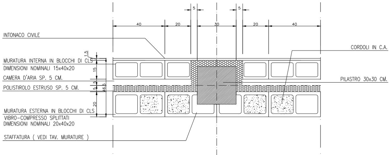
Tamponamento interno in blocchi di calcestruzzo vibro-compresi tipo “Vibrapac” sono delle dimensioni nominali di 15x40x20.
