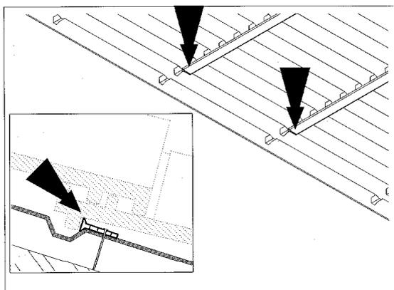
Posizionare i listelli all'interno delle apposite impronte, come rappresentato in figura. Il fissaggio degli stessi verrà realizzato in corrispondenza della cima delle onde della lastra ISOLINE.
