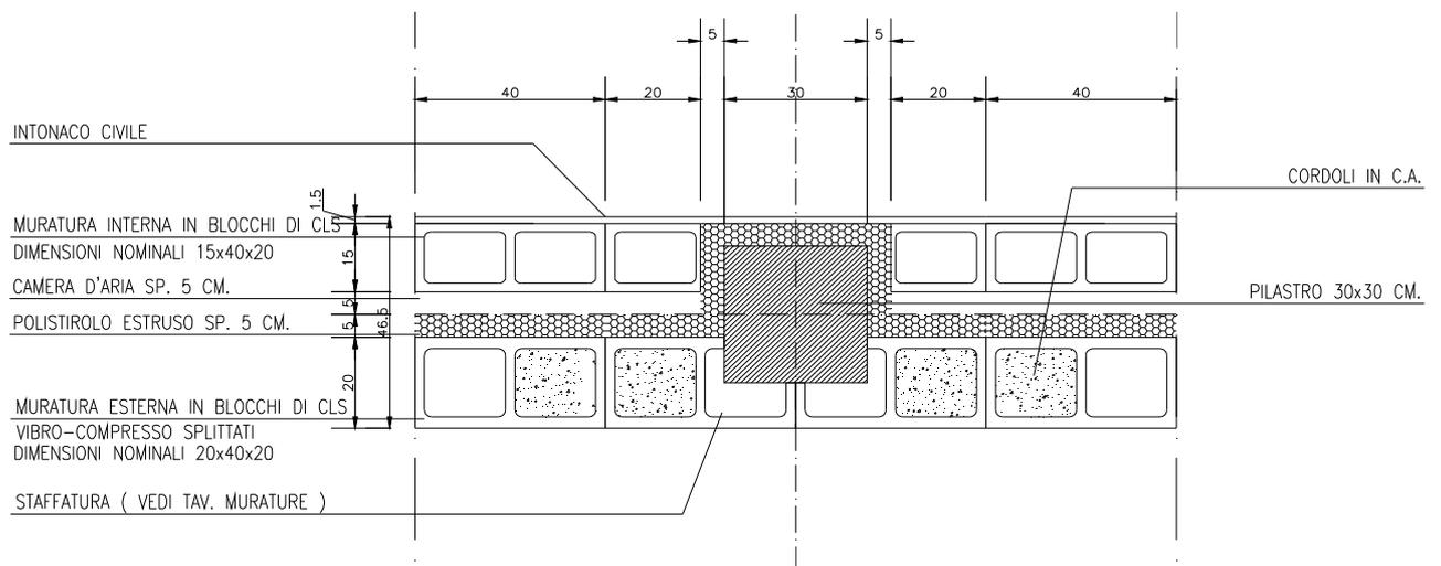
Tamponamento interno in blocchi di calcestruzzo vibro-compresi tipo “Vibrapac” sono delle dimensioni nominali di 15x40x20.
