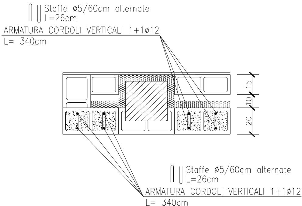
Come prevede la normativa, le due murature interna ed esterna devono essere collegate. Tali collegamenti sono realizzati tramite tralicci zancati di larghezza pari a 20 cm, composti da 2 $\varnothing 5$  + diagonali  $\varnothing 4$  con passo di 40 cm, inseriti ogni tre corsi di mattoni, posizionati tra le 2 murature. Nelle murature perimetrali viene inserito un cordolo orizzontale lungo tutto il perimetro dell'edificio che fa anche da architrave a porte e finestre. ( Vedere esempio sotto )
