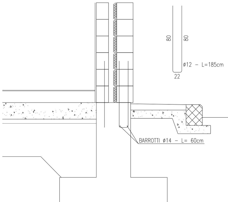
Le coibentazioni corrono lungo il perimetro della muratura esterna per uno spessore di 10 cm. La coibentazione è costituita da una camera d'aria di spessore 5 cm e da uno strato di polistirolo estruso di spessore 3 cm. con tolleranza di posa di 5 cm..
