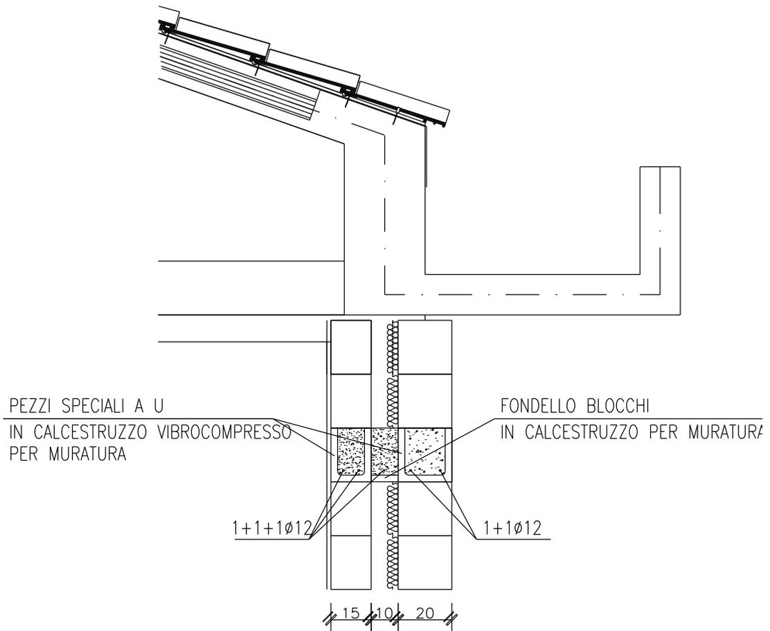
I cordoli orizzontali sono armati con  $3\phi 12 + 2\phi 12$  come da figura sopra.
