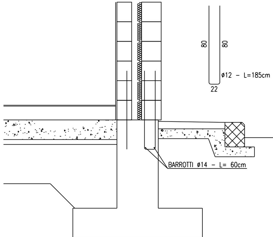
Le coibentazioni corrono lungo il perimetro della muratura esterna per uno spessore di 10 cm. La coibentazione è costituita da una camera d'aria di spessore 5 cm e da uno strato di polistirolo estruso di spessore 3 cm. con tolleranza di posa di 5 cm..
