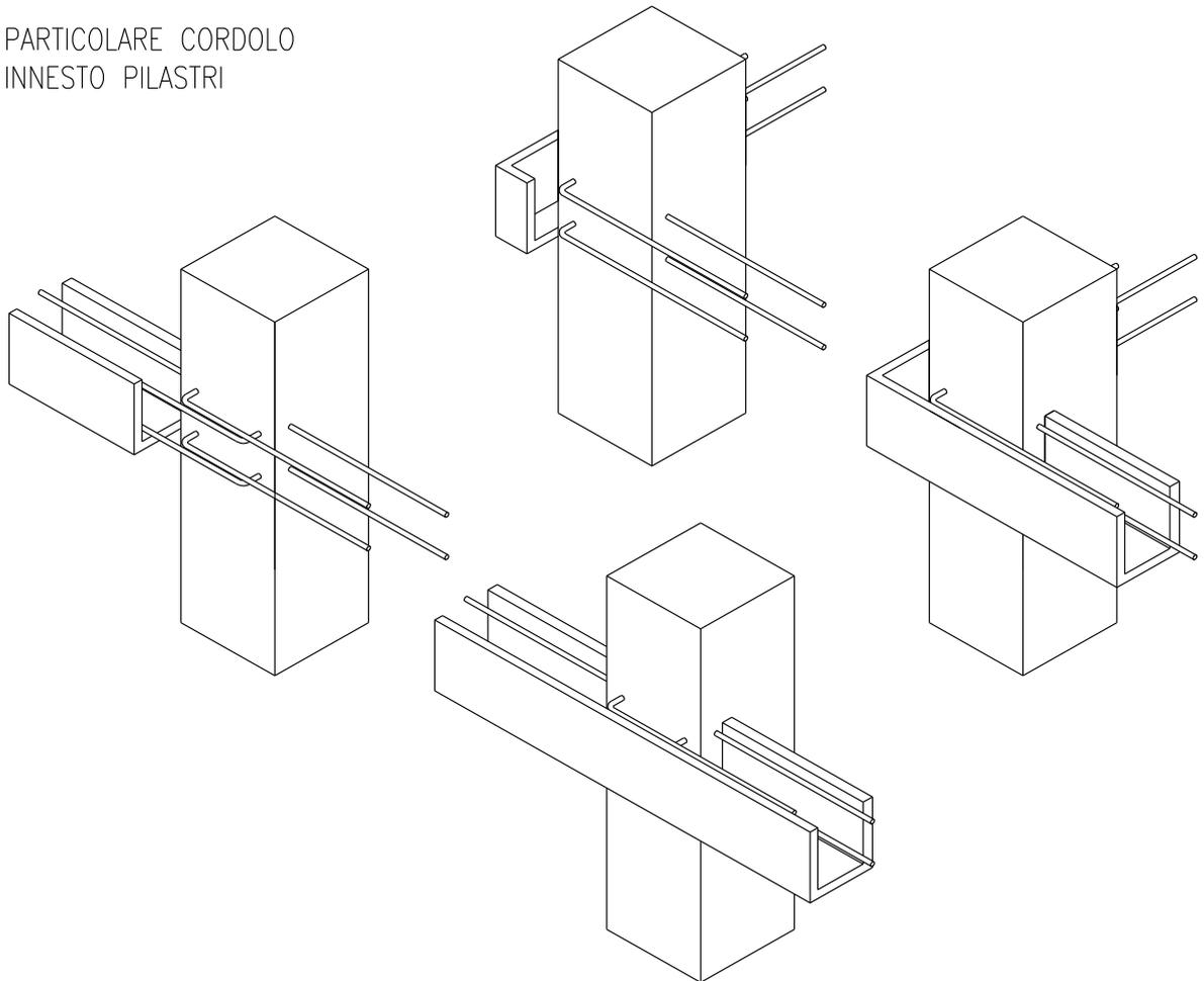
Particolare attenzione si deve al cordolo orizzontale quando incontra il pilastro a cui viene collegato tramite innesti chimici come da immagine 3d sopra riportata.
