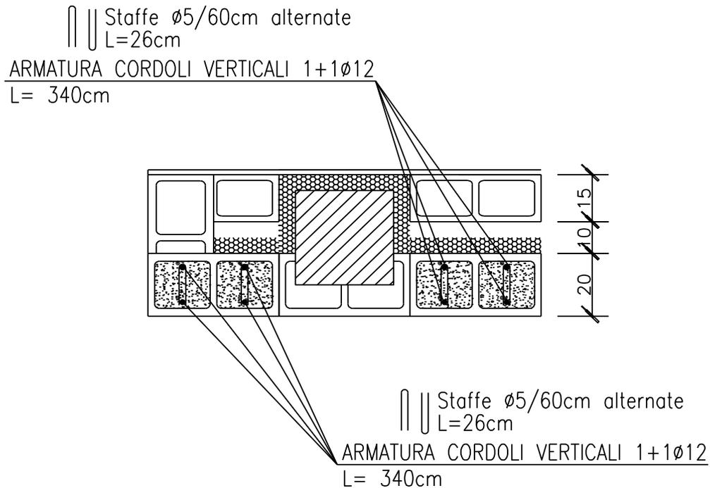
Come prevede la normativa, le due murature interna ed esterna devono essere collegate. Tali collegamenti sono realizzati tramite tralicci zancati di larghezza pari a 20 cm, composti da 2 $\phi 5$  + diagonali  $\phi 4$  con passo di 40 cm, inseriti ogni tre corsi di mattoni, posizionati tra le 2 murature.. Nelle murature perimetrali viene inserito un cordolo orizzontale lungo tutto il perimetro dell'edificio che fa anche da architrave a porte e finestre. ( Vedere esempio sotto )
