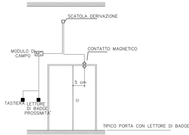
INSTALLAZIONE TIPO COMPONENTI IMPIANTO ANTINTRUSIONE
