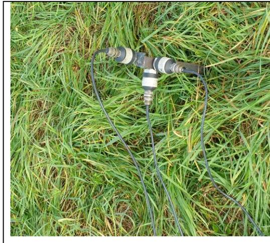
Figura 3 Accelerometri monoassiali collegati a paletto in acciaio infisso nel terreno
