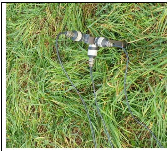
Figura 4 Accelerometri monoassiali collegati a paletto in acciaio infisso nel terreno
