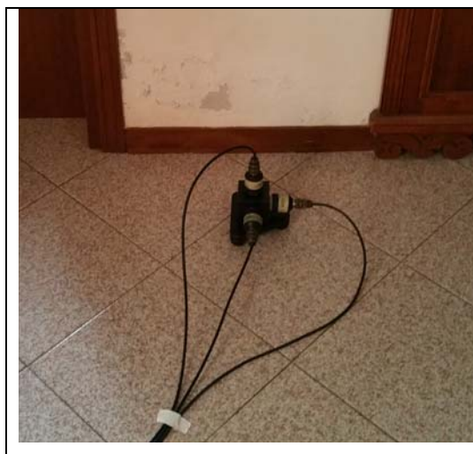
Figura 5: Accelerometri applicati alla basetta in acciaio e fissati al pavimento con cera d'api
