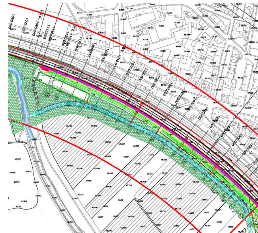
Figura. 6.5. Tratto del tracciato interessato dalla deviazione di corsi d'acqua minori, affluenti del fiume Adige.
