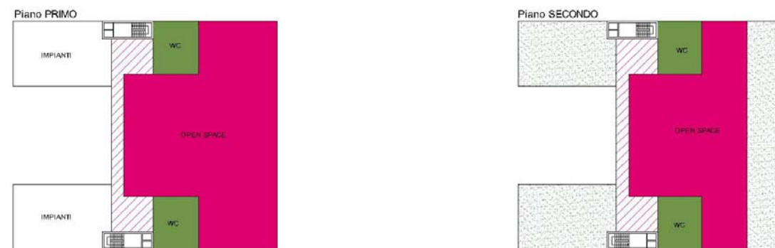
Figura 4.28 - Edificio terminal bus: Schemi distributivi
