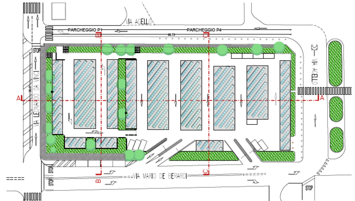
Figura 4.21 - Parcheggi P1-P4: configurazione finale livello copertura
