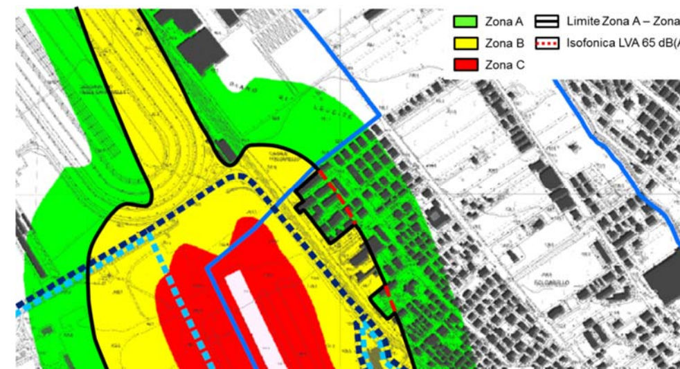
Figura 5-7 Zonizzazione acustica aeroportuale approvata dalla Regione Lazio: classificazione del territorio in funzione dei Piani regolatori
