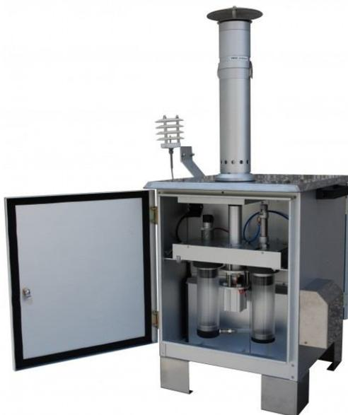
**Figure 4.2 - Skypost Hv utilizzato per il monitoraggio delle polveri**
