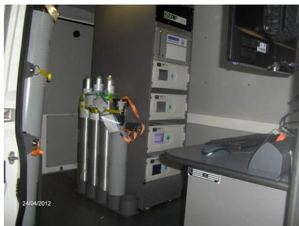
**Figure 4.1-2 Allestimento Laboratorio Mobile – Analizzatori e Campionatori Sequenziali**
