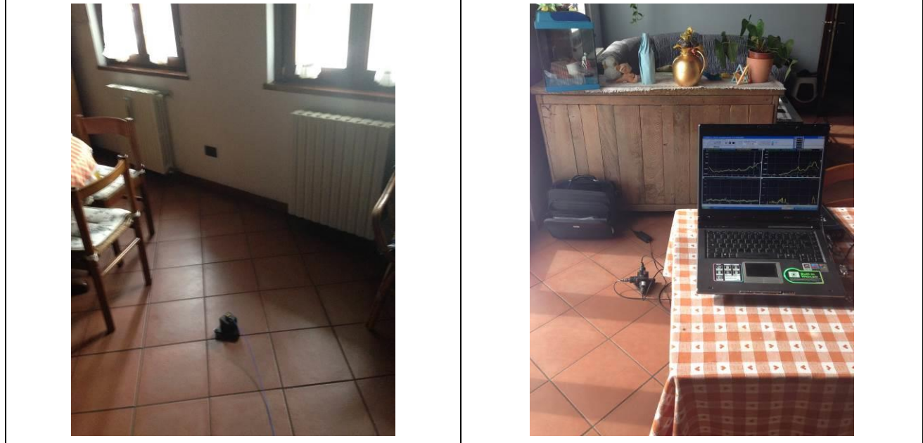
Posizionamento accelerometro triassiale, 1° piano f.t. Posizionamento accelerometri monoassiali, 2° piano f.t.
