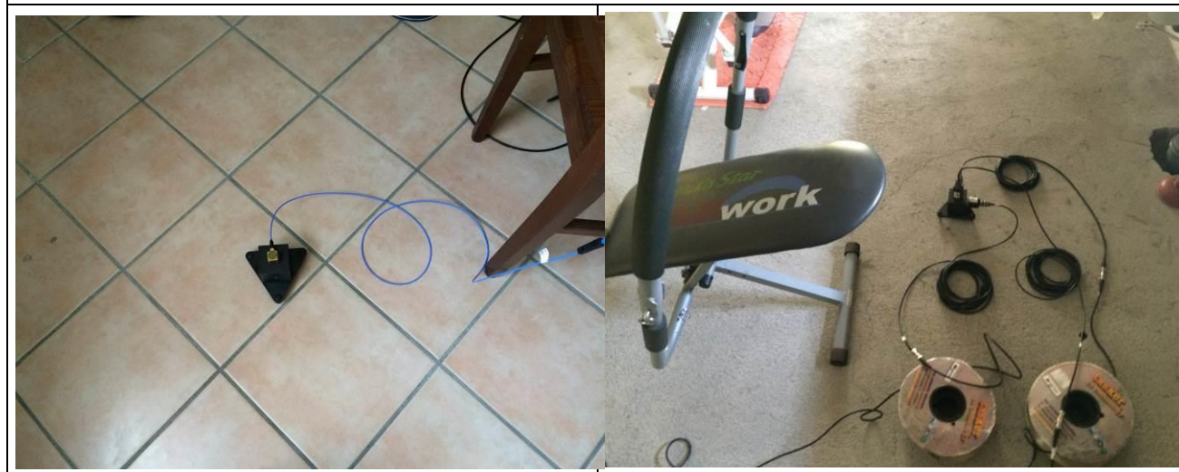
Posizionamento accelerometro triassiale, 1° piano f.t. Posizionamento accelerometri monoassiali, 2° piano f.t.
