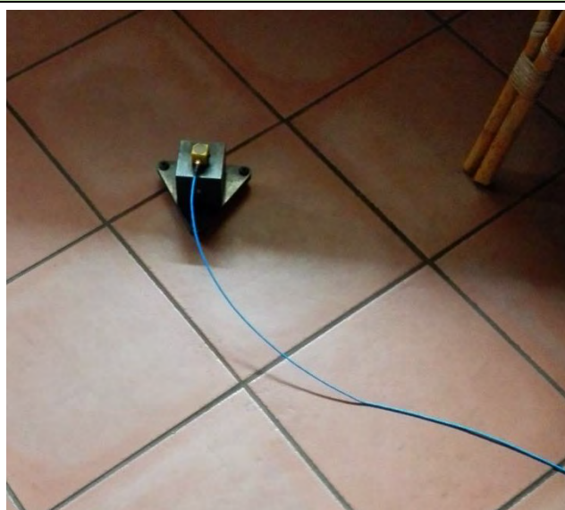
Posizionamento accelerometro triassiale, 1° piano f.t.
