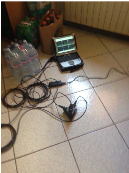
Posizionamento accelerometri monoassiali, 1° piano f.t.
