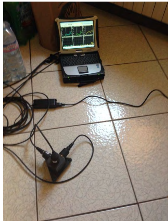
Posizionamento accelerometri monoassiali, 1° piano f.t.
