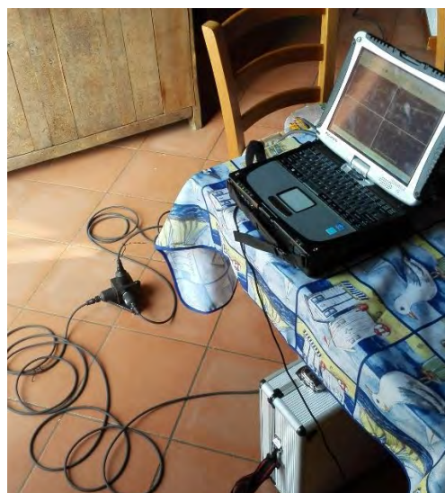
Posizionamento accelerometri monoassiali, 2° piano f.t.
