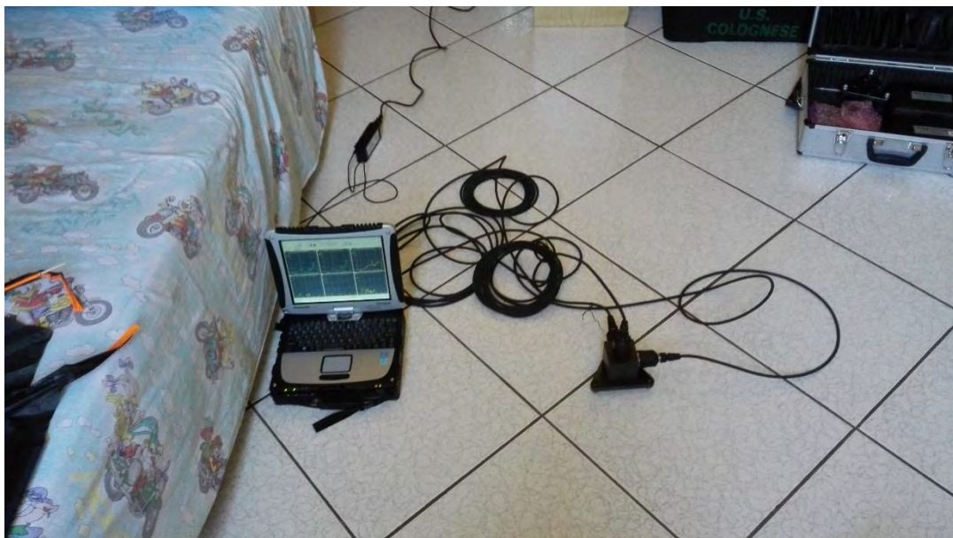
Posizionamento accelerometri monoassiali, 1° piano f.t.
