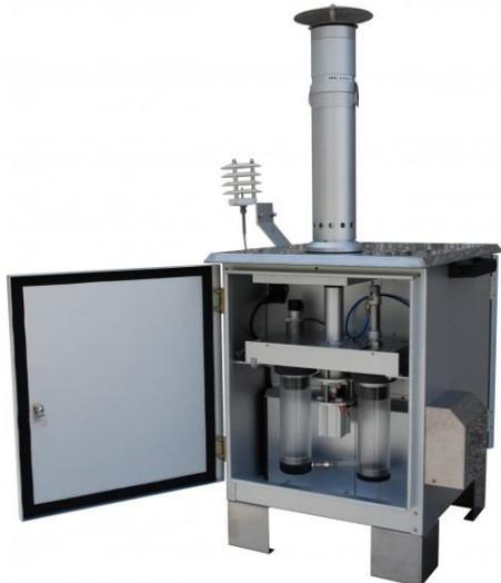
*Figure 5-1 - Skypost Hv utilizzato per il monitoraggio delle PM10*
