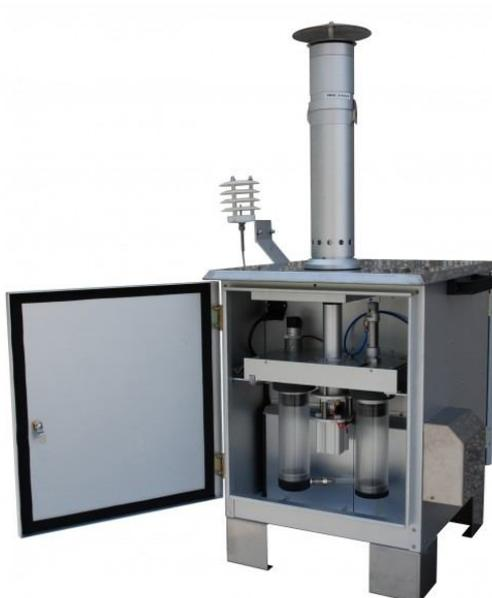
*Figure 5-1 - Skypost Hv utilizzato per il monitoraggio delle PM10*
