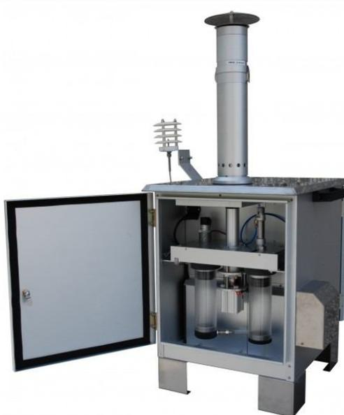
**Figure 5.1 - Skypost Hv utilizzato per il monitoraggio delle polveri**
