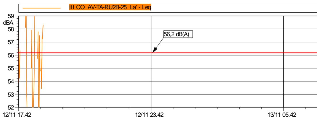
Non essendo stati raggiunti i requisiti per considerare stazionario il rumore emesso dal cantiere il Metodo B della norma UNI 10855 non è applicabile ed è possibile solo l'utilizzo del Metodo C della citata norma.
