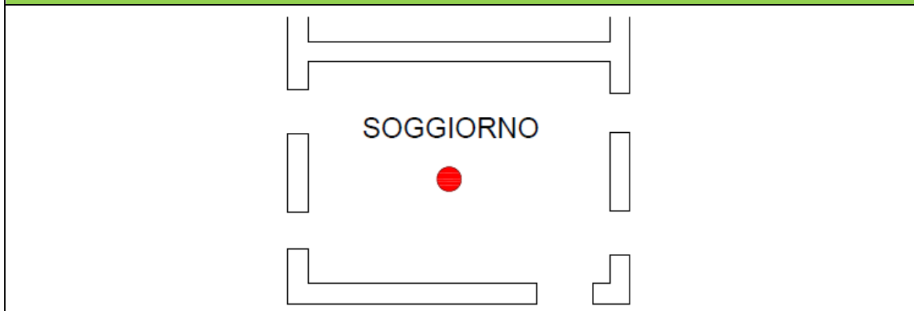
Posizionamento accelerometro triassiale, 1° piano f.t.
