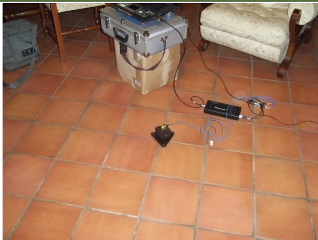
Posizionamento accelerometro triassiale, 1° piano f.t.
