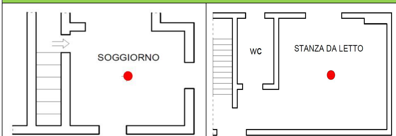
Posizionamento accelerometro triassiale, 2° piano f.t.
