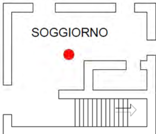
Posizionamento accelerometro triassiale, 1° piano f.t.
