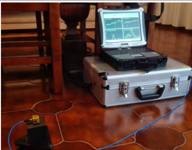
Posizionamento accelerometro triassiale, 1° piano f.t.
