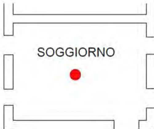
Posizionamento accelerometro triassiale, 1° piano f.t.
