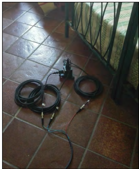
Posizionamento accelerometro triassiale, 3° piano f.t.
