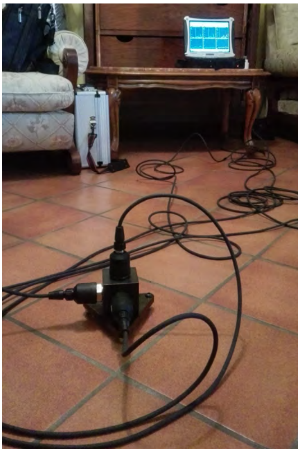
Posizionamento accelerometro triassiale, 1° piano f.t.
