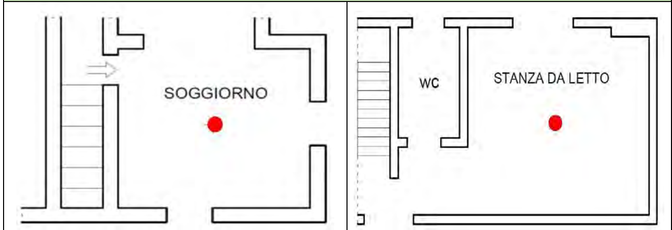
Posizionamento accelerometro triassiale, 2° piano f.t.
