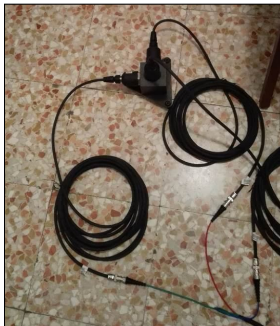
Posizionamento accelerometri monoassiali, 2° piano f.t.
