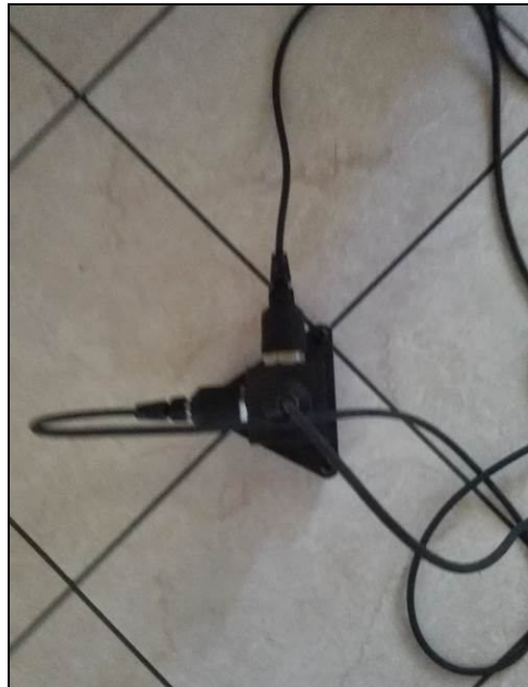
Posizionamento accelerometro triassiale, 1° piano f.t.
