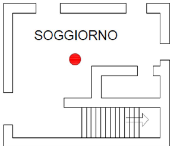
Posizionamento accelerometro triassiale, 1° piano f.t.
