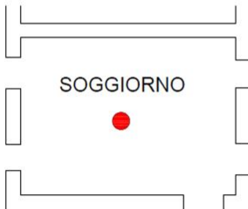
Posizionamento accelerometro triassiale, 1° piano f.t.
