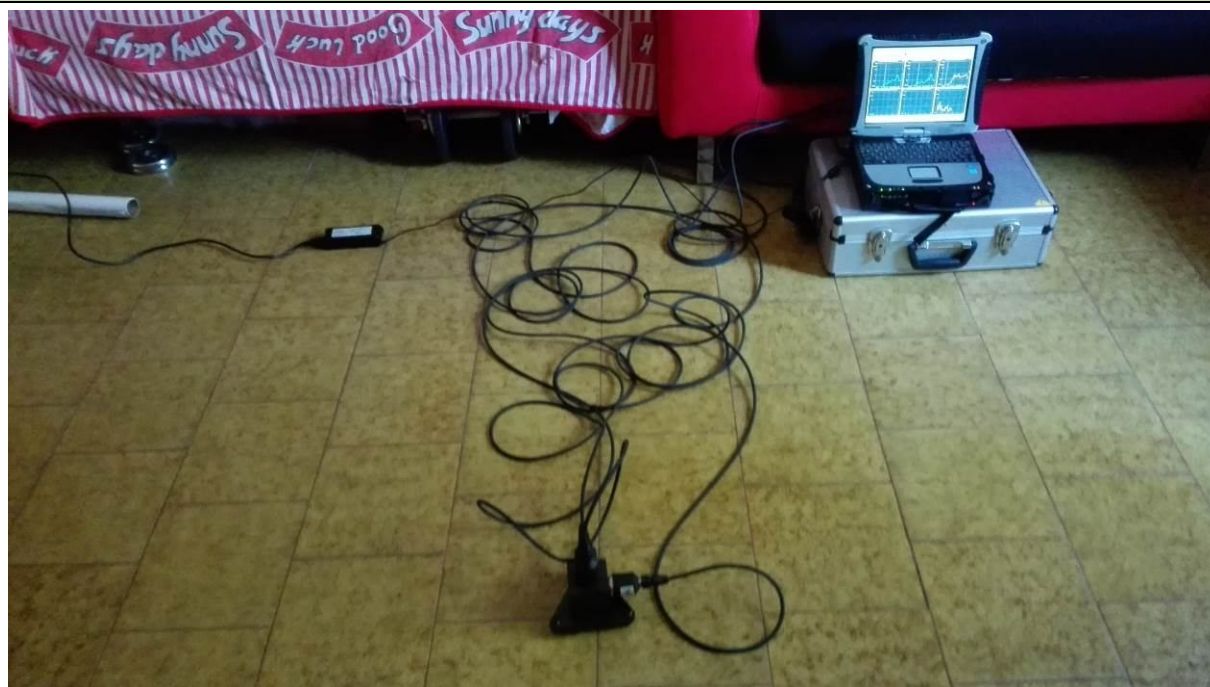
Posizionamento accelerometro triassiale, 2° piano f.t.
