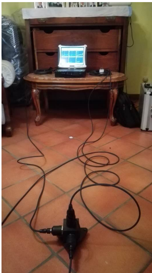
Posizionamento accelerometro triassiale, 1° piano f.t.
