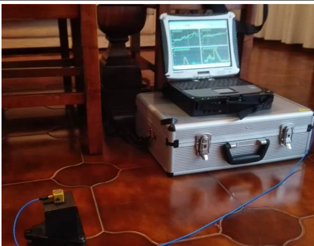
Posizionamento accelerometro triassiale, 1° piano f.t.
