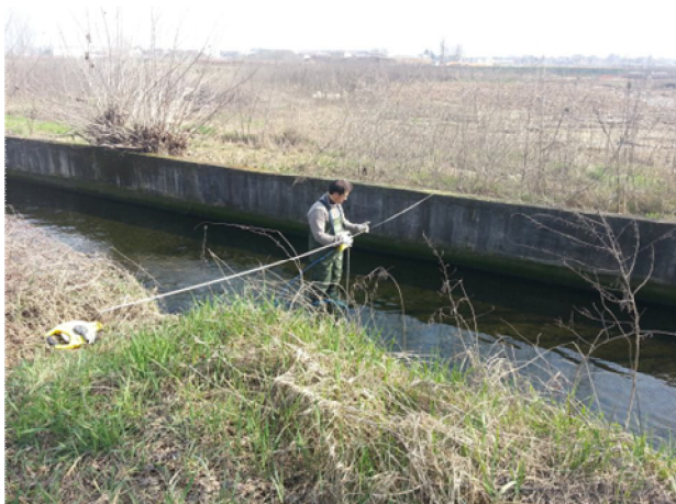
Misura portata AV-TA-SU-1-19 (Monte)
