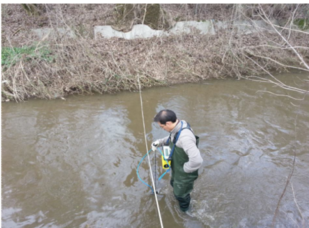
Misura portata AV-TA-SU-1-21 (Monte)
