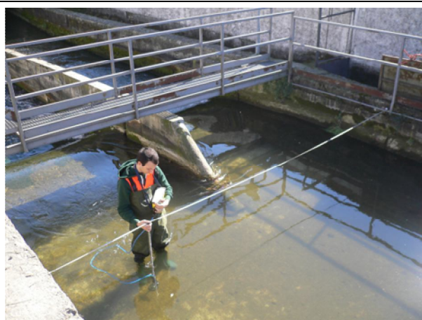
Misura portata AV-RO-SU-1-18 (Valle)
