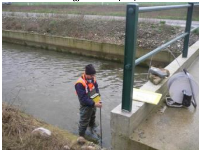
Prova di portata Roggia Castellana (Valle)
