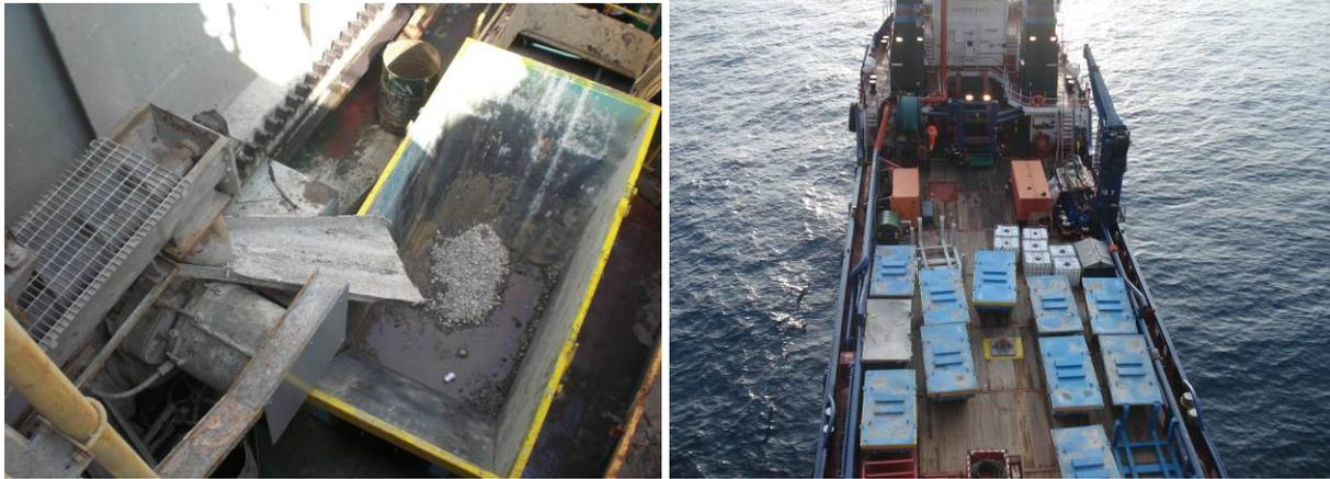
10. il Fango di Perforazione (dopo esser transitato attraverso tutti i sistemi di rimozione solidi precedentemente citati) ritorna nelle vasche impianto per essere ricondizionato e ripompato in pozzo.
