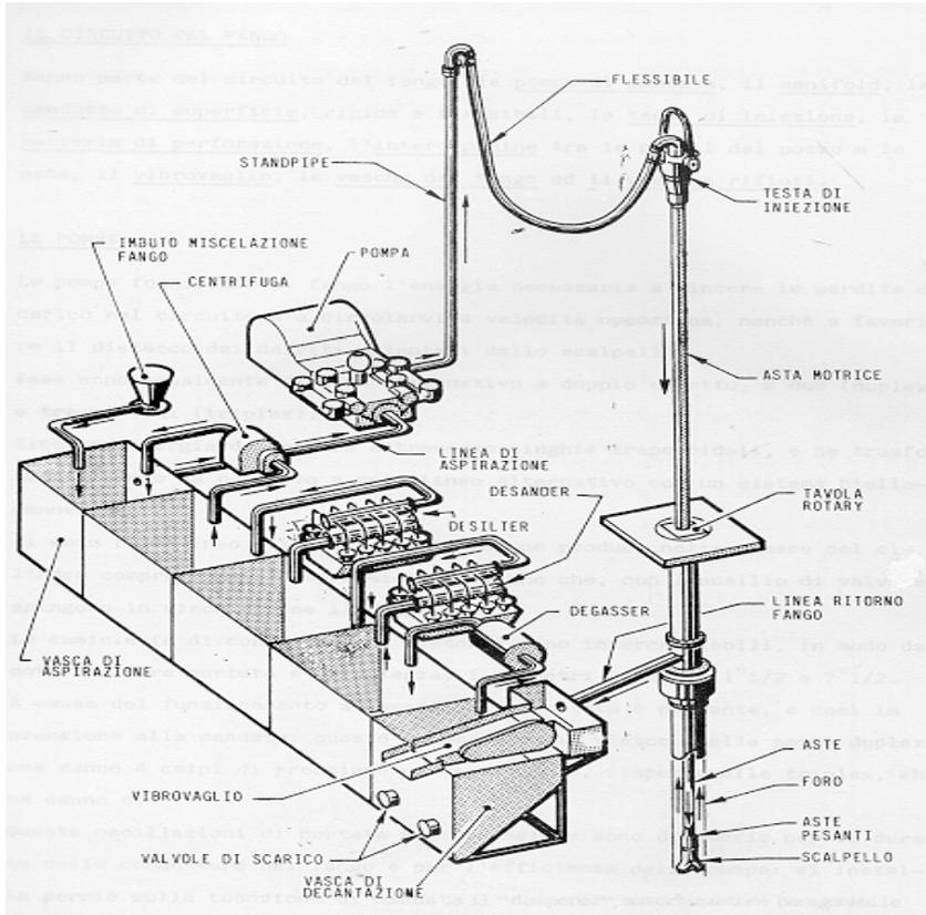
Nel circuito sono inoltre inserite diverse vasche di stoccaggio contenenti una riserva di fluido adeguata a fronteggiare improvvise necessità derivanti da perdite di circolazione (vedi comma c prescrizione A9).
