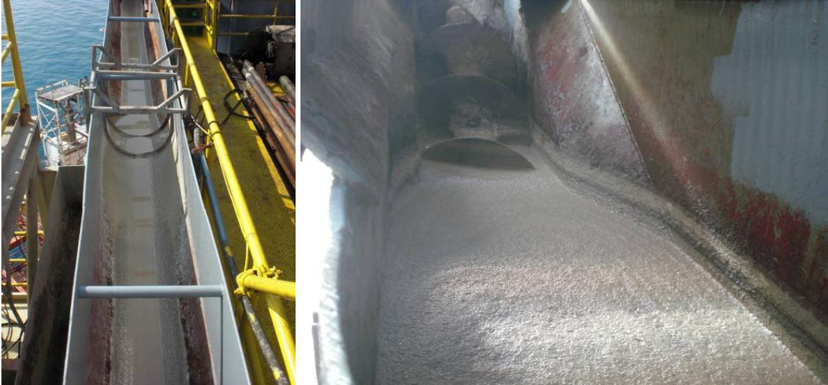
6. Il Fluido di perorazione carico di detriti passa attraverso un sistema di rimozione solidi composto da Vibrovagli (vedi comma b prescrizione A9),
