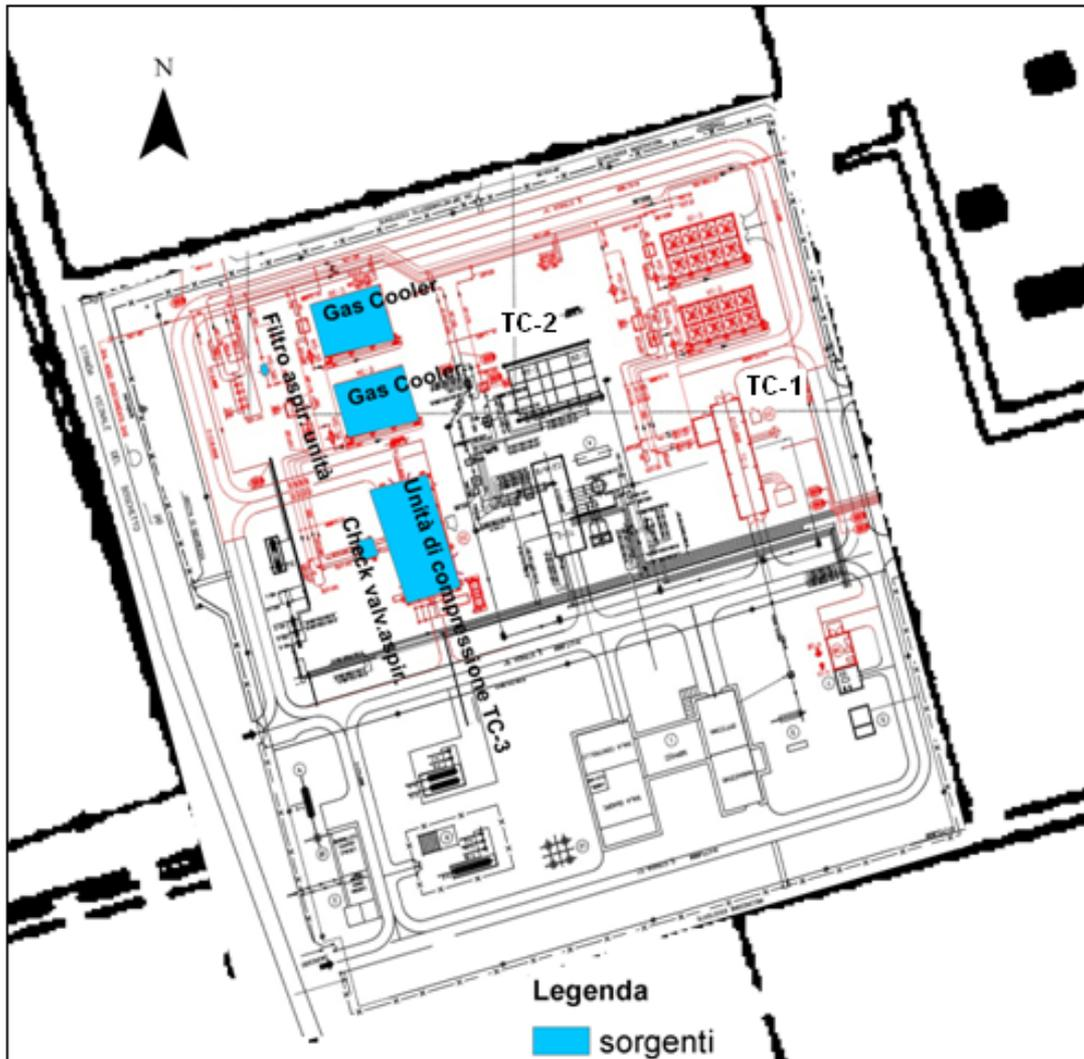
**Fig. 5.6.b – Centrale di Settala, area compressione: localizzazione TC-3 e sorgenti di rumore**
