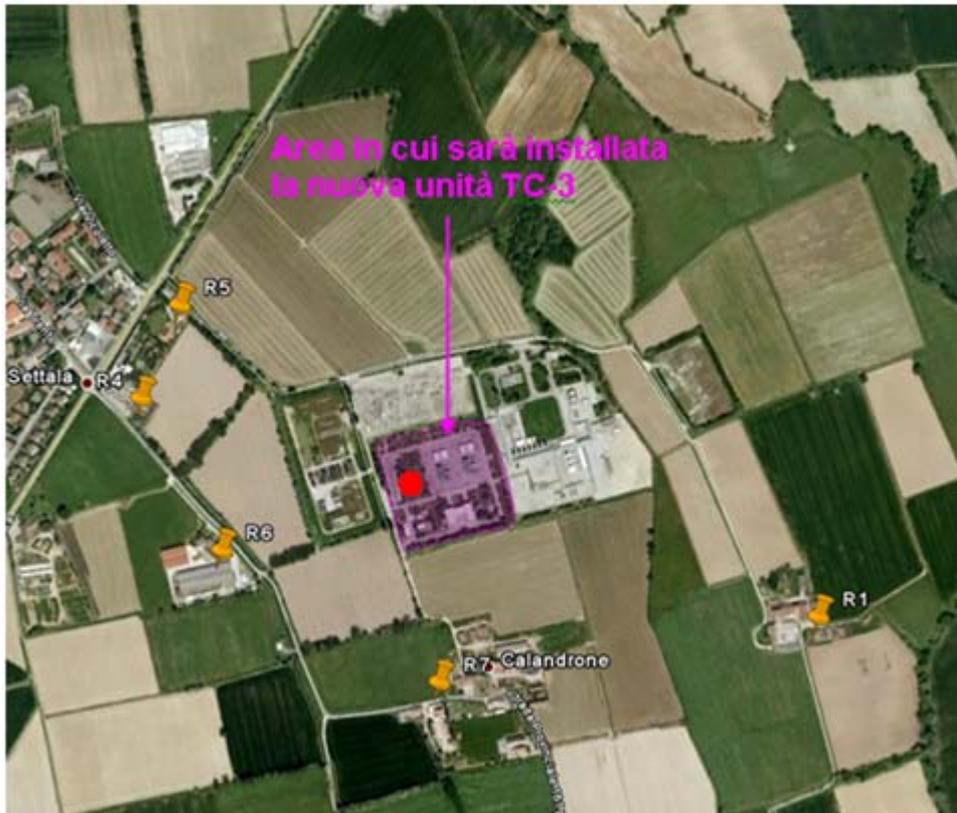
**Figura 6.1.a – Localizzazione proposta dei ricettori per il monitoraggio del clima acustico in fase di esercizio del turbocompressore TC-3**
